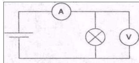
**363.** Определить сопротивление  $R_h$  нити лампочки по показаниям вольтметра ( $U = 50$  В) и амперметра ( $I = 0,5$  А), включенные по приведенной ниже схеме (рис. 8). Сопротивление вольтметра  $R_v = 40$  кОм.
