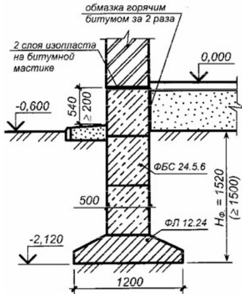
Рис. 9. Конструкции сборных ленточных фундаментов: а – под наружные стены в здании без подвала
