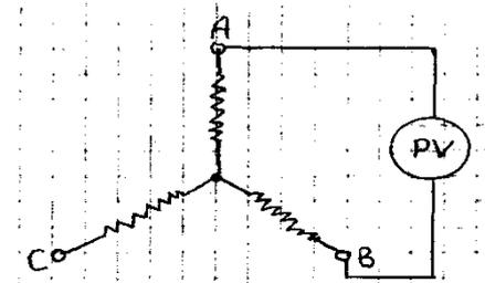
Определить показание вольтметра электромагнитной системы в ненагруженной цепи.
