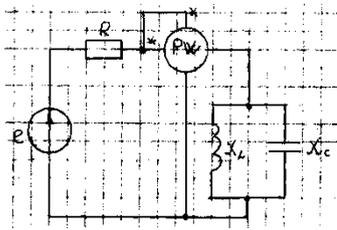
Определить показание ваттметра.
