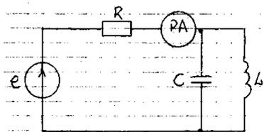
Определить показание амперметра электромагнитной системы.
