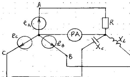
Определить ток в нулевом проводе при несимметричной нагрузке трехфазной цепи.
