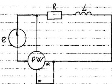
Определить показание ваттметра.
