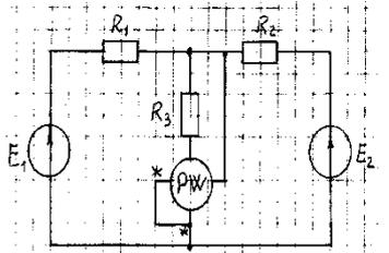
В электрической схеме определить показание ваттметра.
