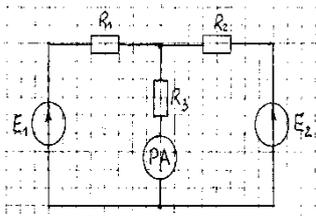
В электрической схеме определить показание амперметра.
