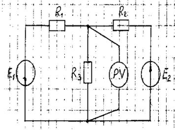
В электрической схеме определить показание вольтметра.
