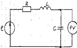
Определить показание вольтметра электромагнитной системы.
