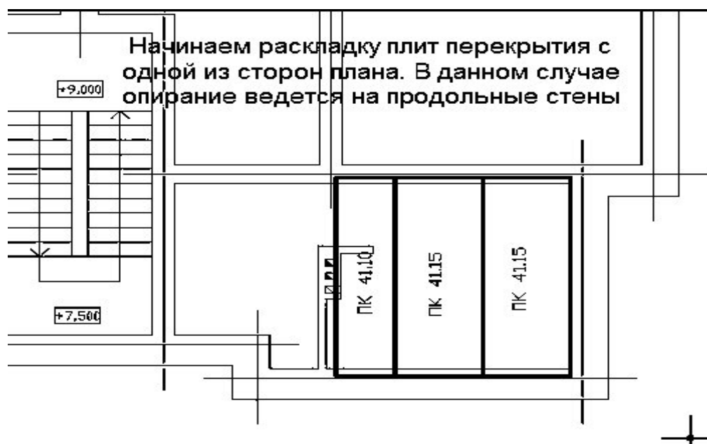
Рисунок 8. Начальный этап раскладки плит
