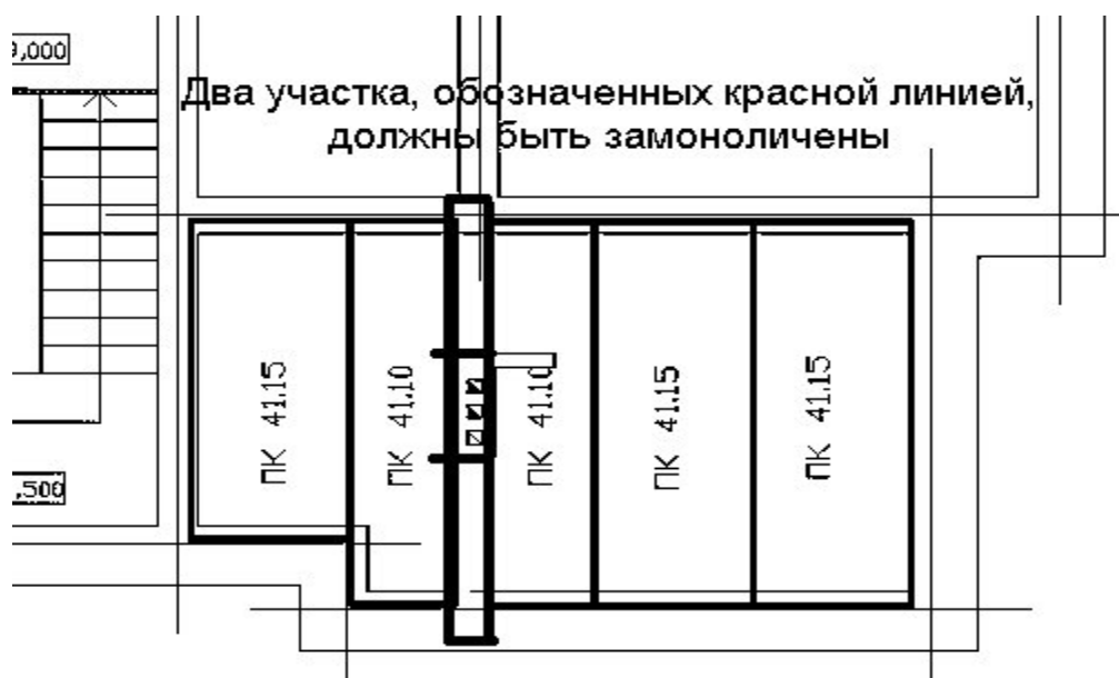
Рисунок 8. Завершающий этап раскладки плит
