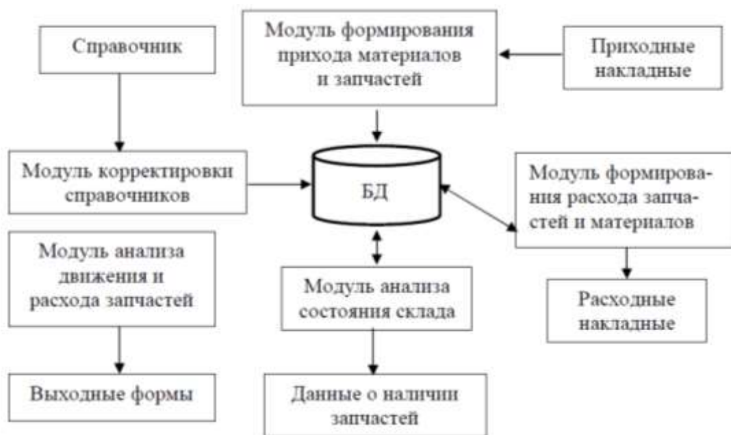
Рисунок 13 - Функциональная схема АРМ склада
