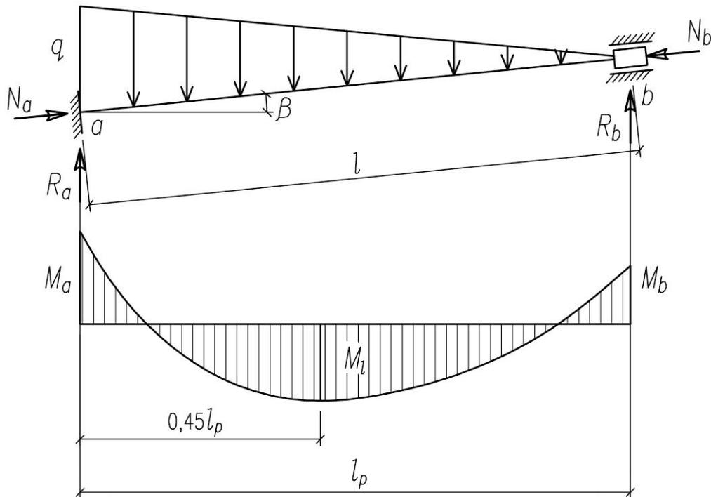
Рис. 5. Расчетная схема ребра купола
