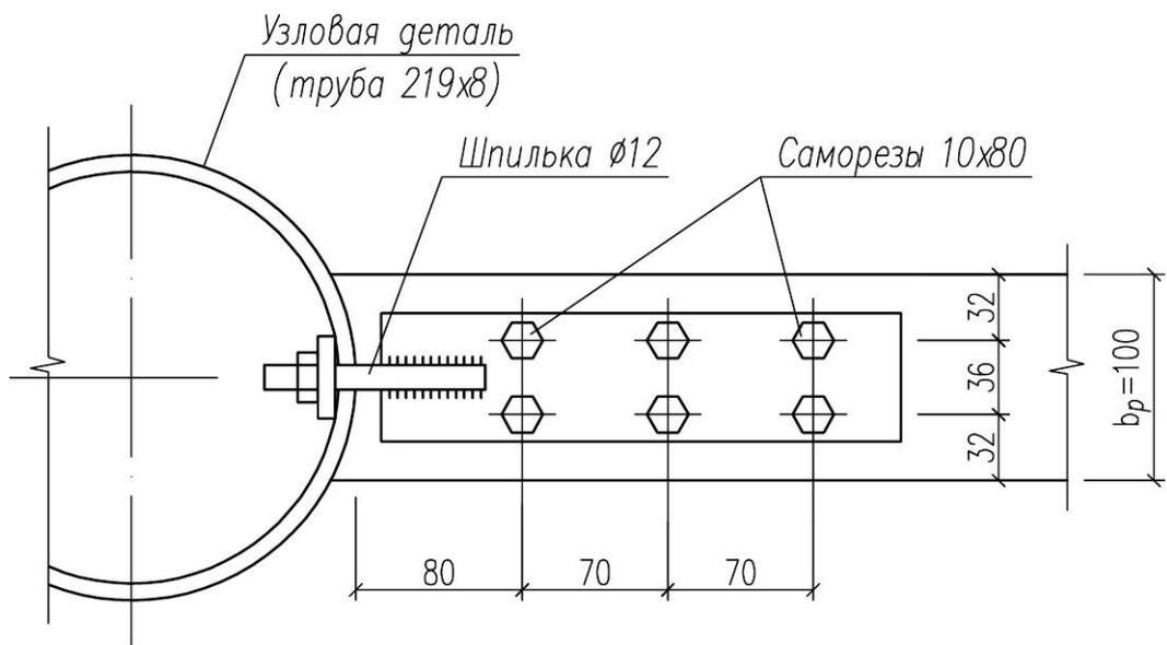
Рис. 6. Конструкция и расчетная схема узла купола
