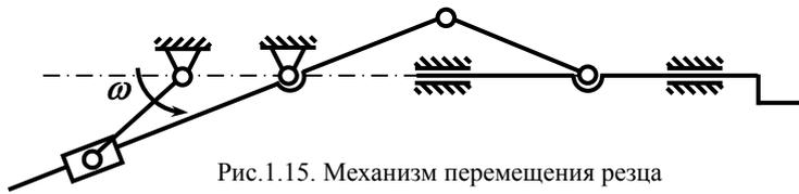
Рис.1.15. Механизм перемещения резца
