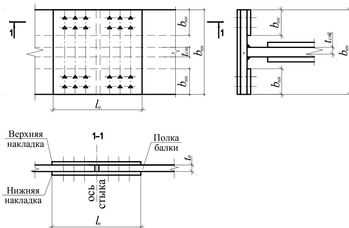
Рис. 10. Размещение болтов в стыке полок
