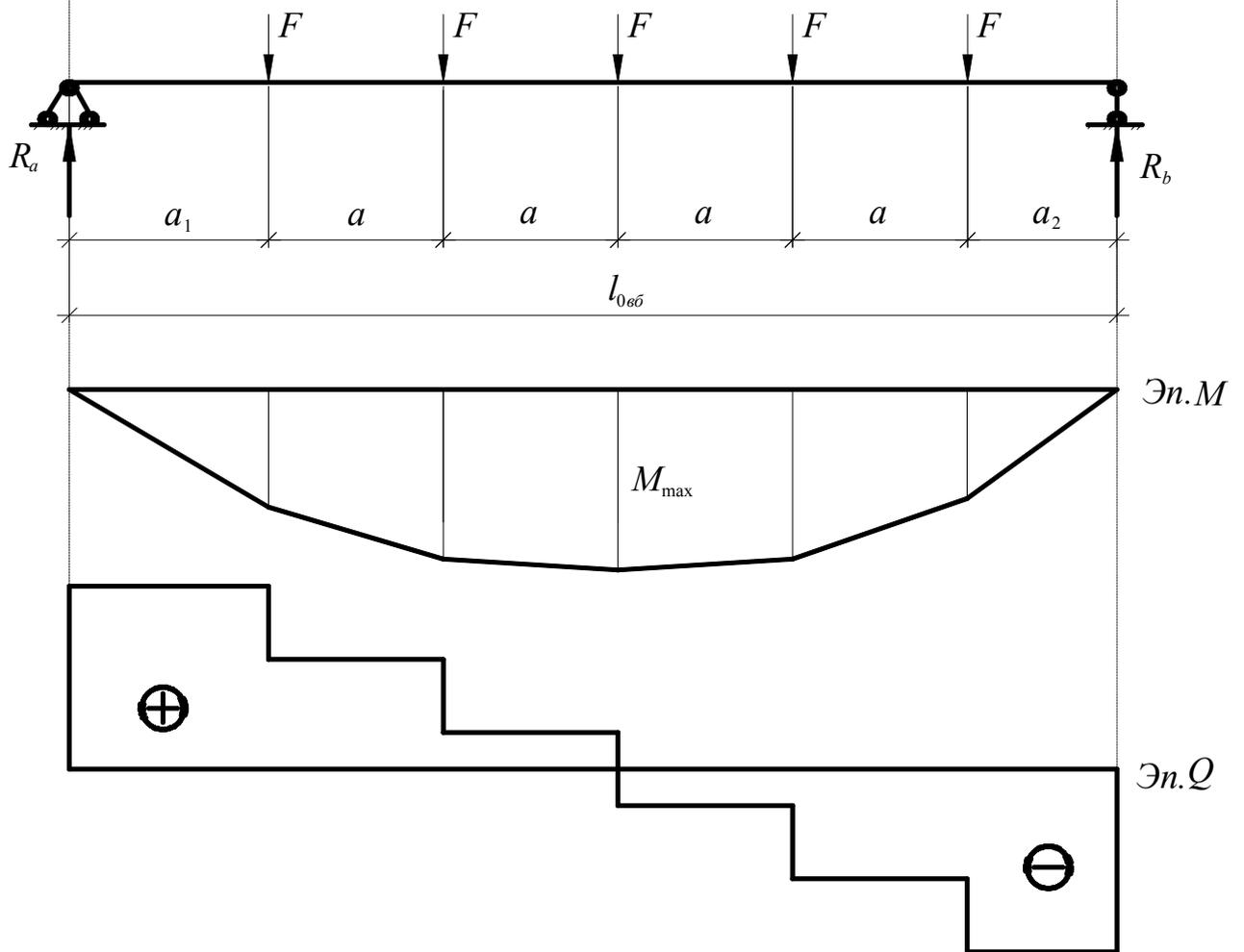
Рис. 2. Конструктивная и расчетная схемы главной балки
