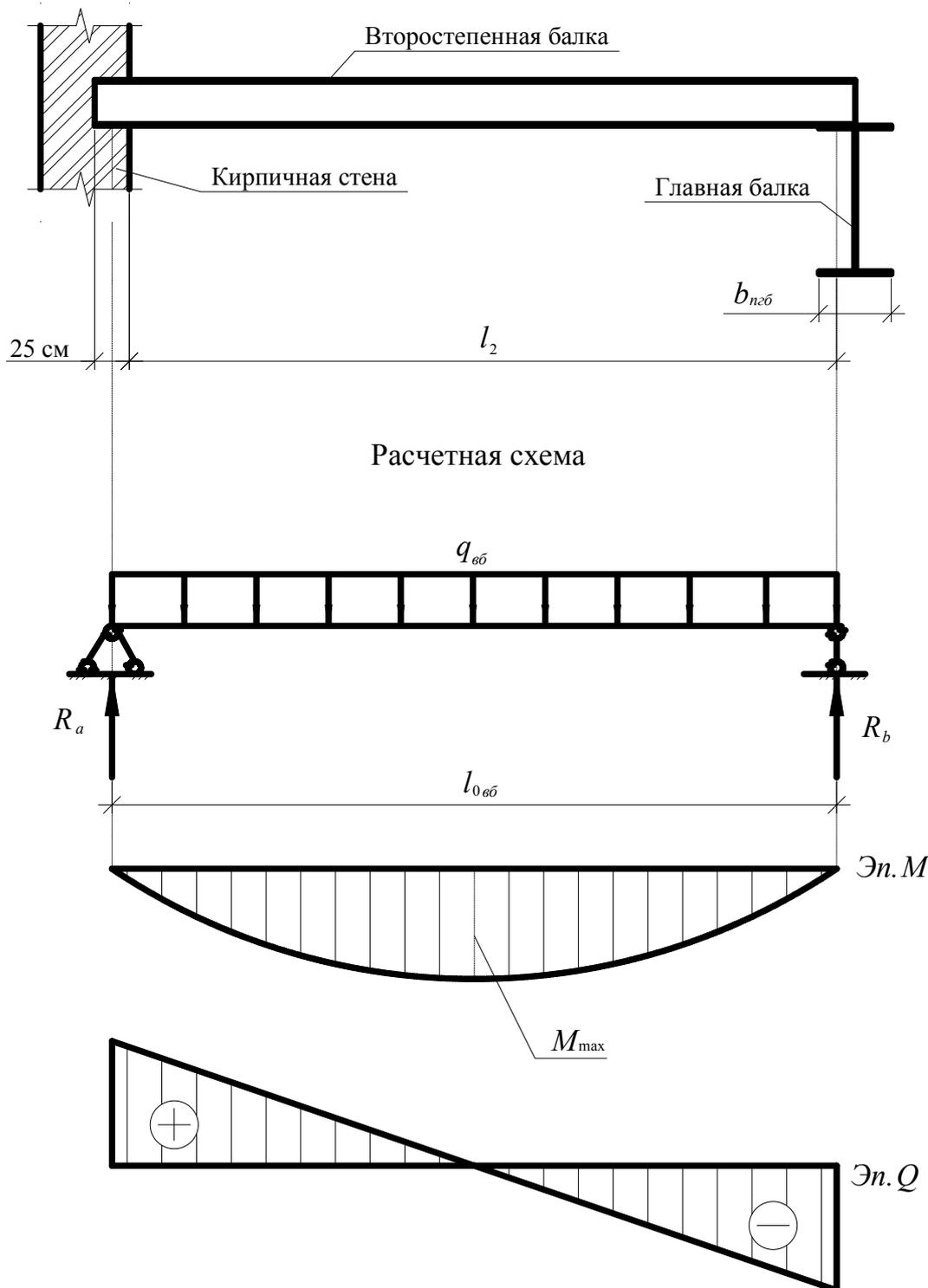
Рис. 1. Конструктивная и расчетная схемы второстепенной балки
