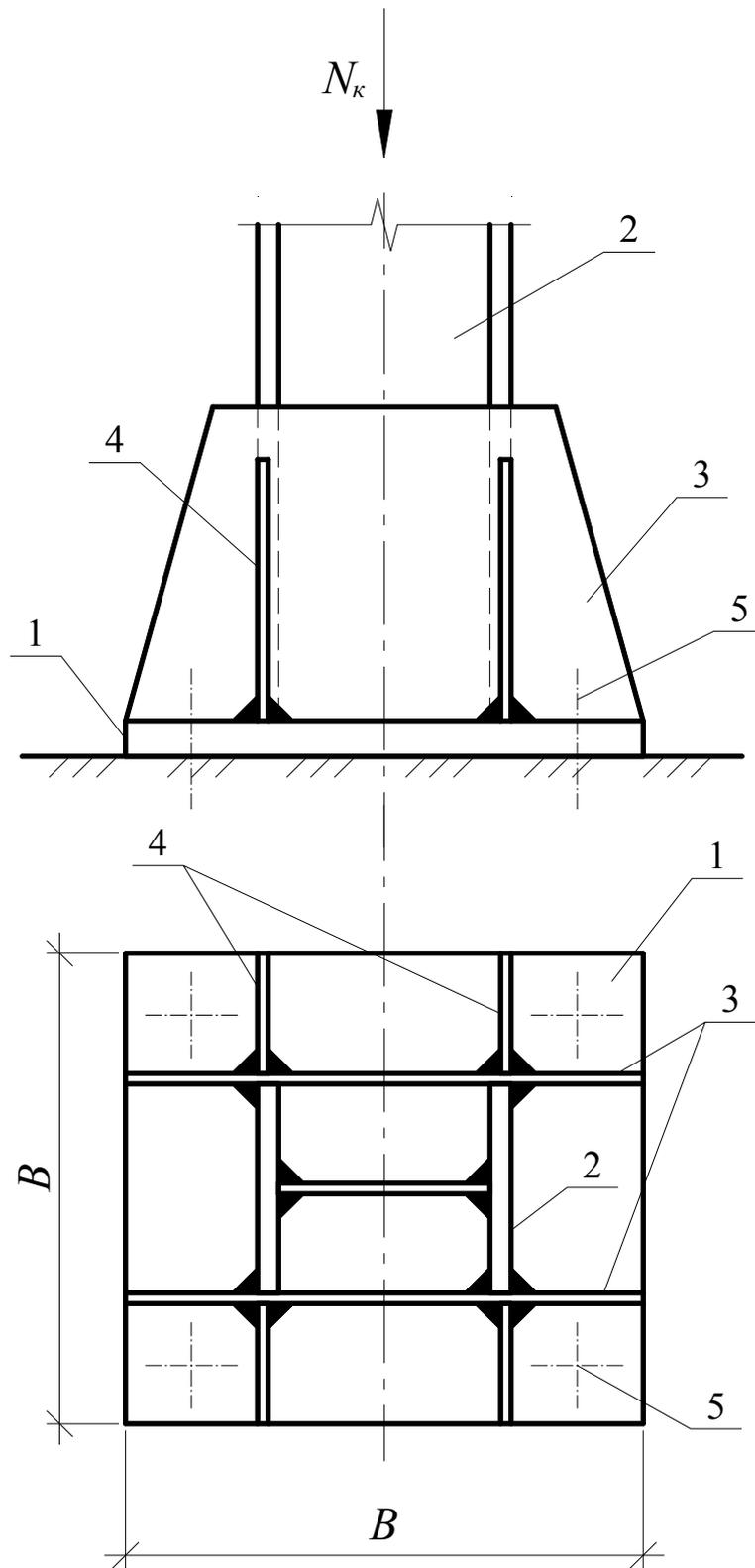
Рис. 15. Конструктивная схема базы колонны:
