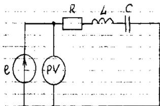
Определить показание вольтметра электромагнитной системы.
