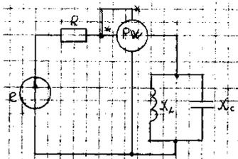
Определить показание ваттметра.
