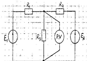
В электрической схеме определить показание вольтметра.
