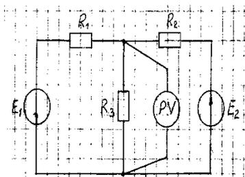
В электрической схеме определить показание вольтметра.
