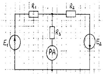
В электрической схеме определить показание амперметра.
