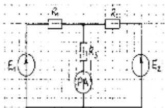
В электрической схеме определить показание амперметра.
