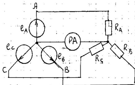
Определить показание амперметра в нулевом проводе симметричной трехфазной цепи.
