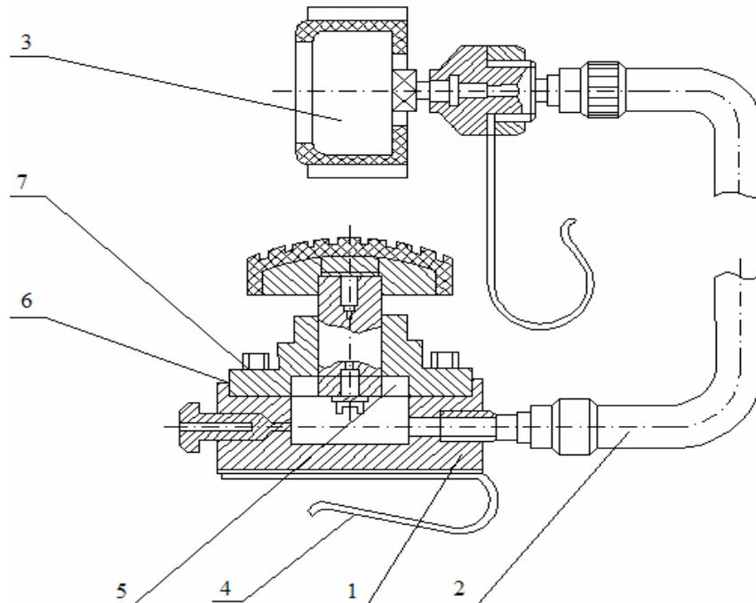
Рисунок 10 - Устройство силоизмерительное: 1 – корпус; 2 – трубка; 3 – манометр; 4 – захват пружинный; 5 – шток; 6 – крышка; 7 – мембрана
