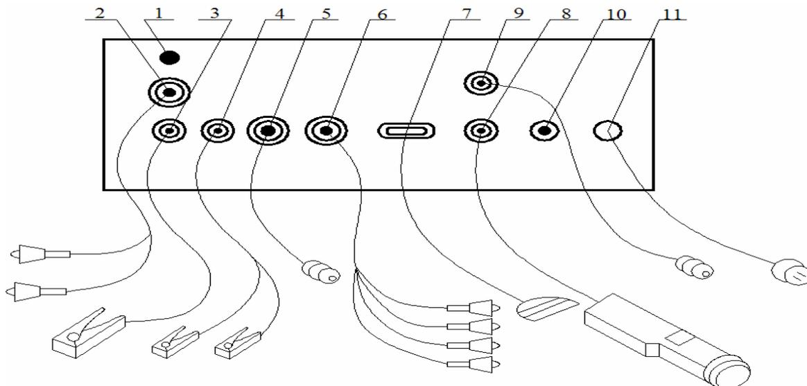
Рисунок 3,б - Панель автотестера модели K297 (задняя)
