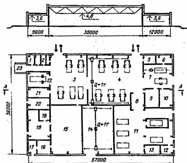
Операции ТО и ТР выполняются на тупиковых постах, оборудованных 2-х стоечными подъемниками. При необходимости, автомобиль может поступать на пост жестяницких работ, а также в окрасочный участок, оборудованный окрасочной камерой.
