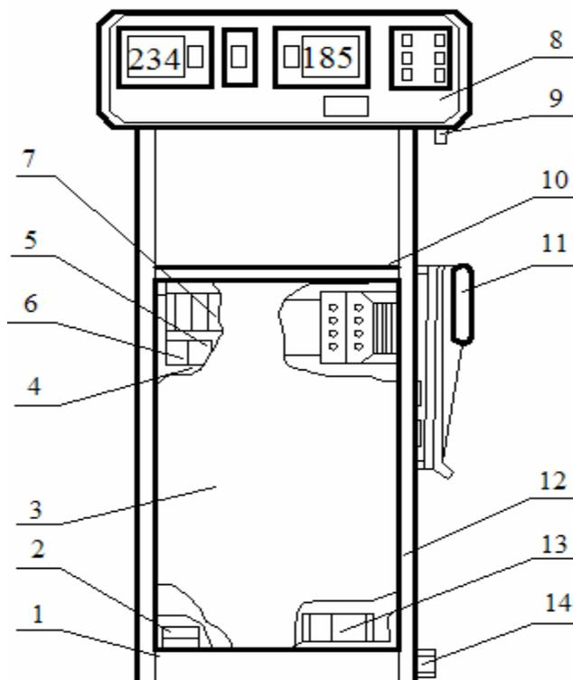
Рисунок 7 - Стойка приборная: 1 – шасси; 2 – блок зажимов; 3 – крышка; 4 – кассета; 5 – потенциометр Р21; 6 – потенциометр Р16; 7 – потенциометр Р14; 8 – блок приборов; 9 – разъем выхода на ВУ; 10 – коврик; 11 – пульт дистанционного управления; 12 – силовой шкаф; 13 – разъем подключения опорного устройства; 14 – болт заземления.
