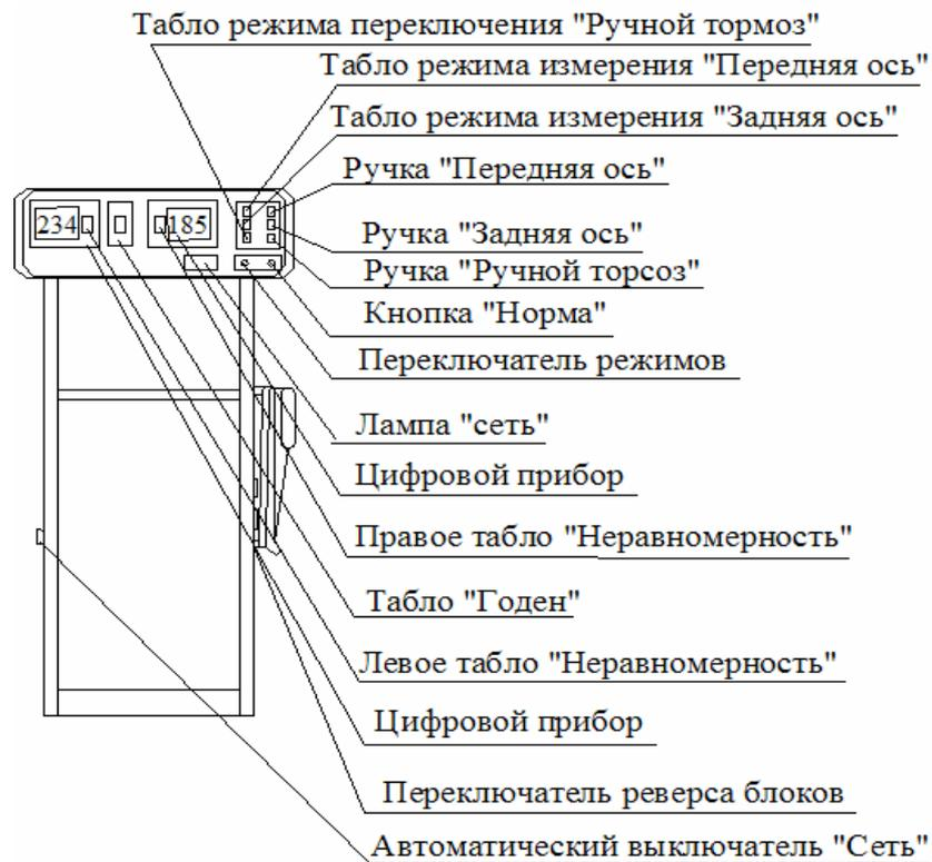
Рисунок 8 - Стойка приборная. Органы управления и индикации
