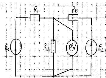
В электрической схеме определить показание вольтметра.
