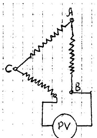
Определить показание вольтметра электромагнитной системы на зажимах разомкнутого «треугольника» трехфазного генератора.
