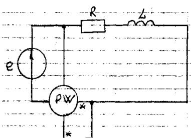
Определить показание ваттметра.
