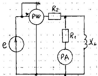
Определить показание ваттметра, если амперметр показывает 5 А.
