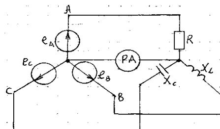
Определить ток в нулевом проводе при несимметричной нагрузке трехфазной цепи.
