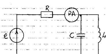
Определить показание амперметра электромагнитной системы.
