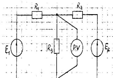
В электрической схеме определить показание вольтметра.
