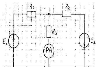
В электрической схеме определить показание амперметра.
