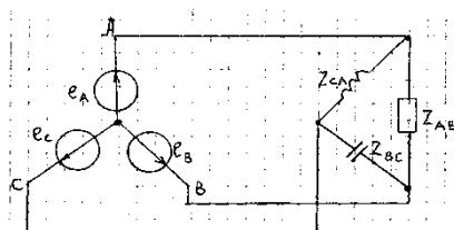
Определить фазный ток нагрузки, соединенной в «треугольник».
