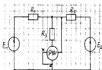
В электрической схеме определить показание ваттметра.
