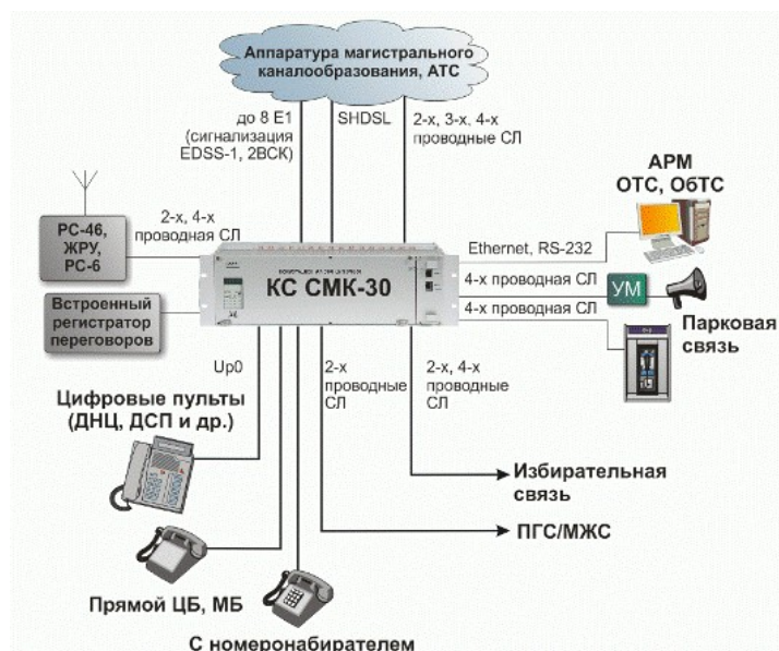
Рисунок 1.1 - Структурная схема аппаратно-программного комплекса связи на СМК-30
