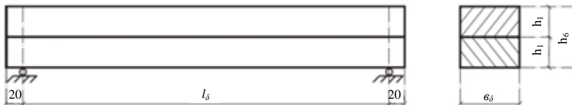
Рис. 4.1. Балка составного сечения без связей
