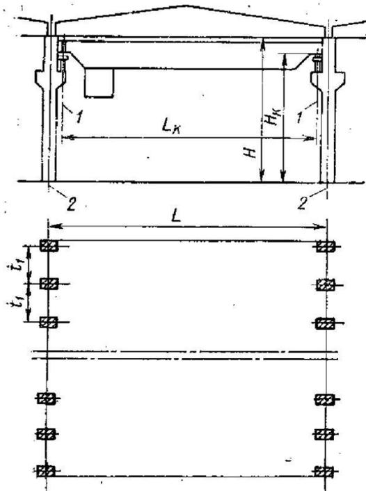
Рисунок 2 – Основные размеры пролета здания и сетки колонн:
