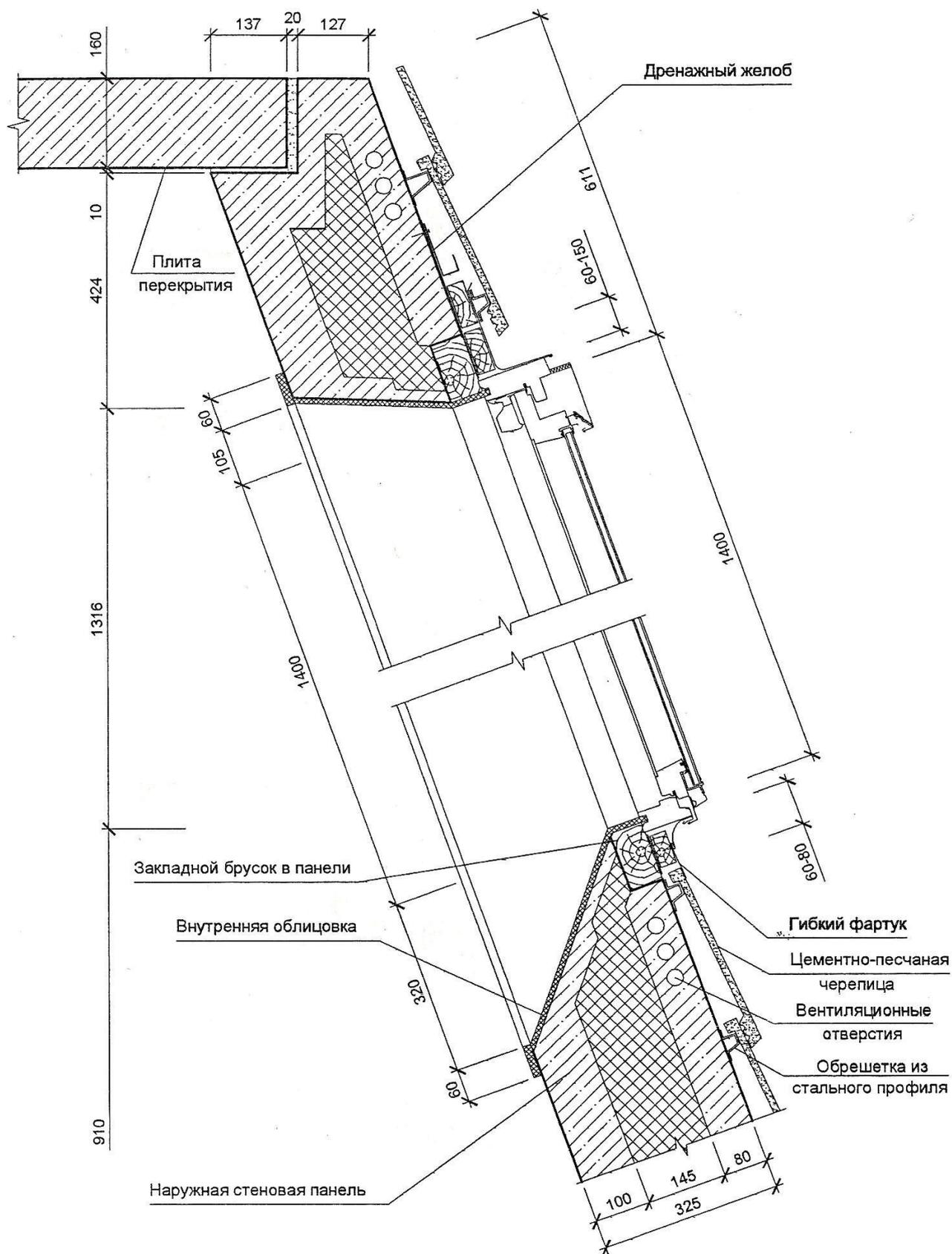
Рис. 24. Узел установки мансардного окна типа "VELUX".
