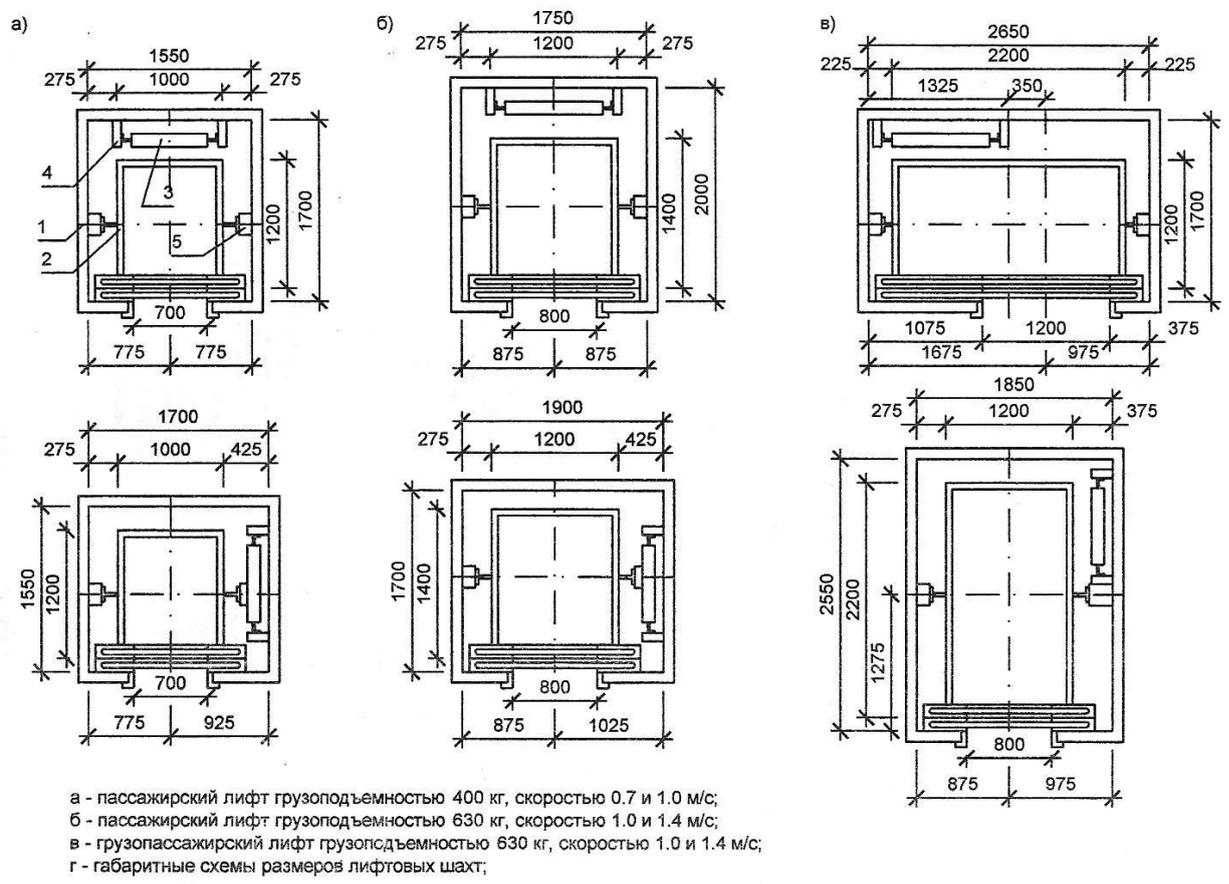
1 - шахта лифта; 2 - кабина лифта; 3 - противовес; 4 - направляющие противовеса; 5 - направляющие кабины
