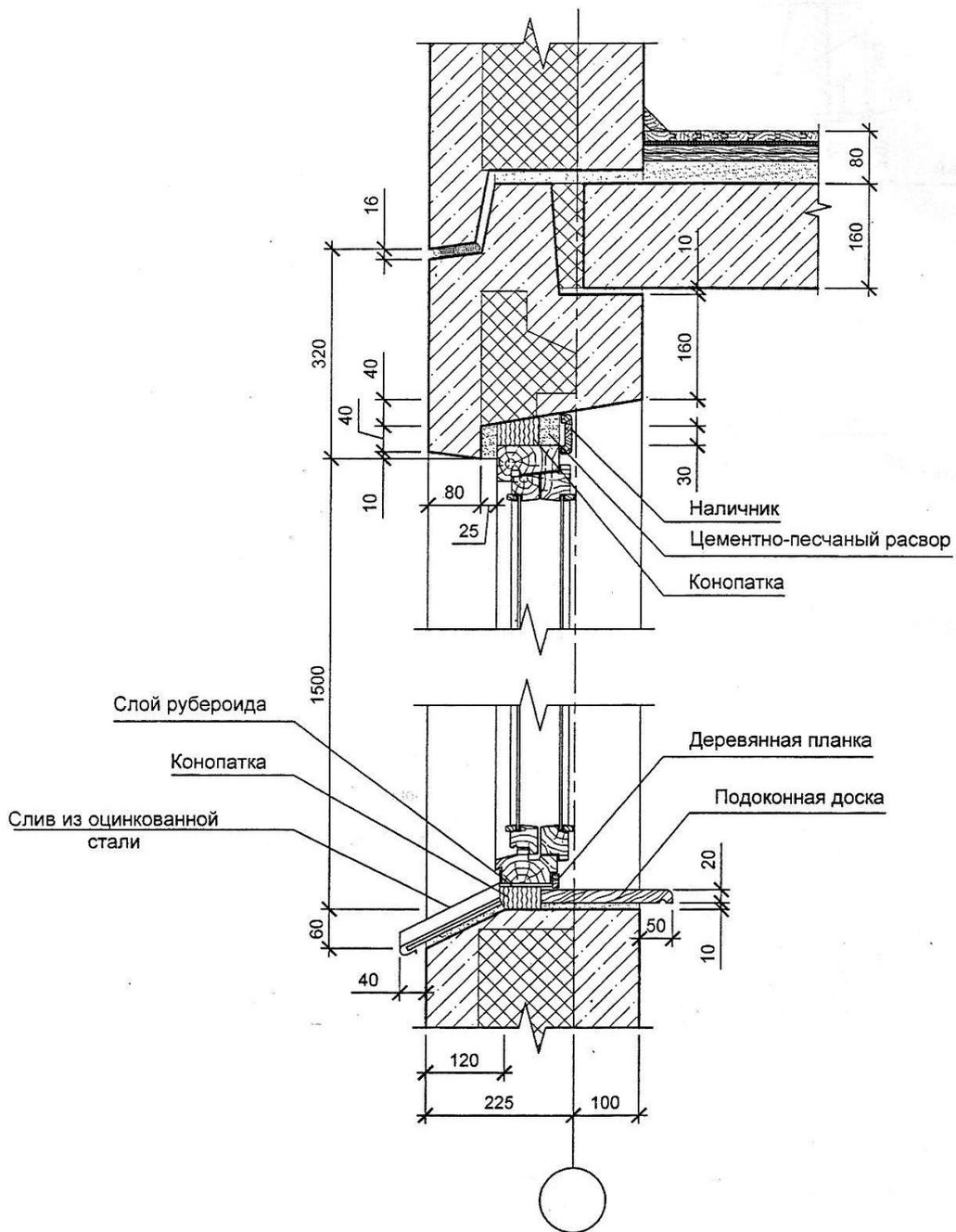
Рис. 23. Конструктивное решение установки оконного блока в проем
