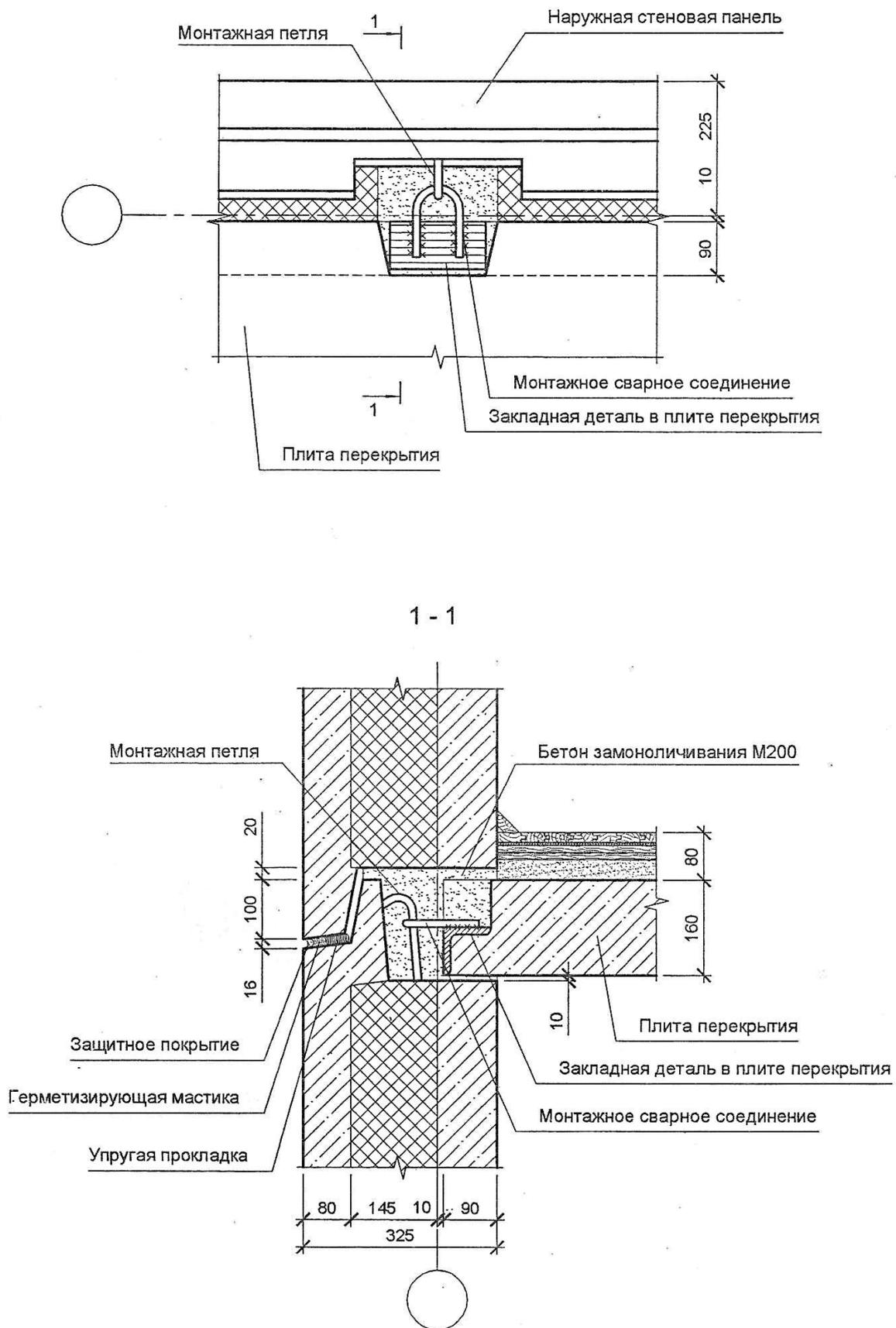
Рис. 30. Вариант сопряжения плит перекрытия и стеновых панелей
