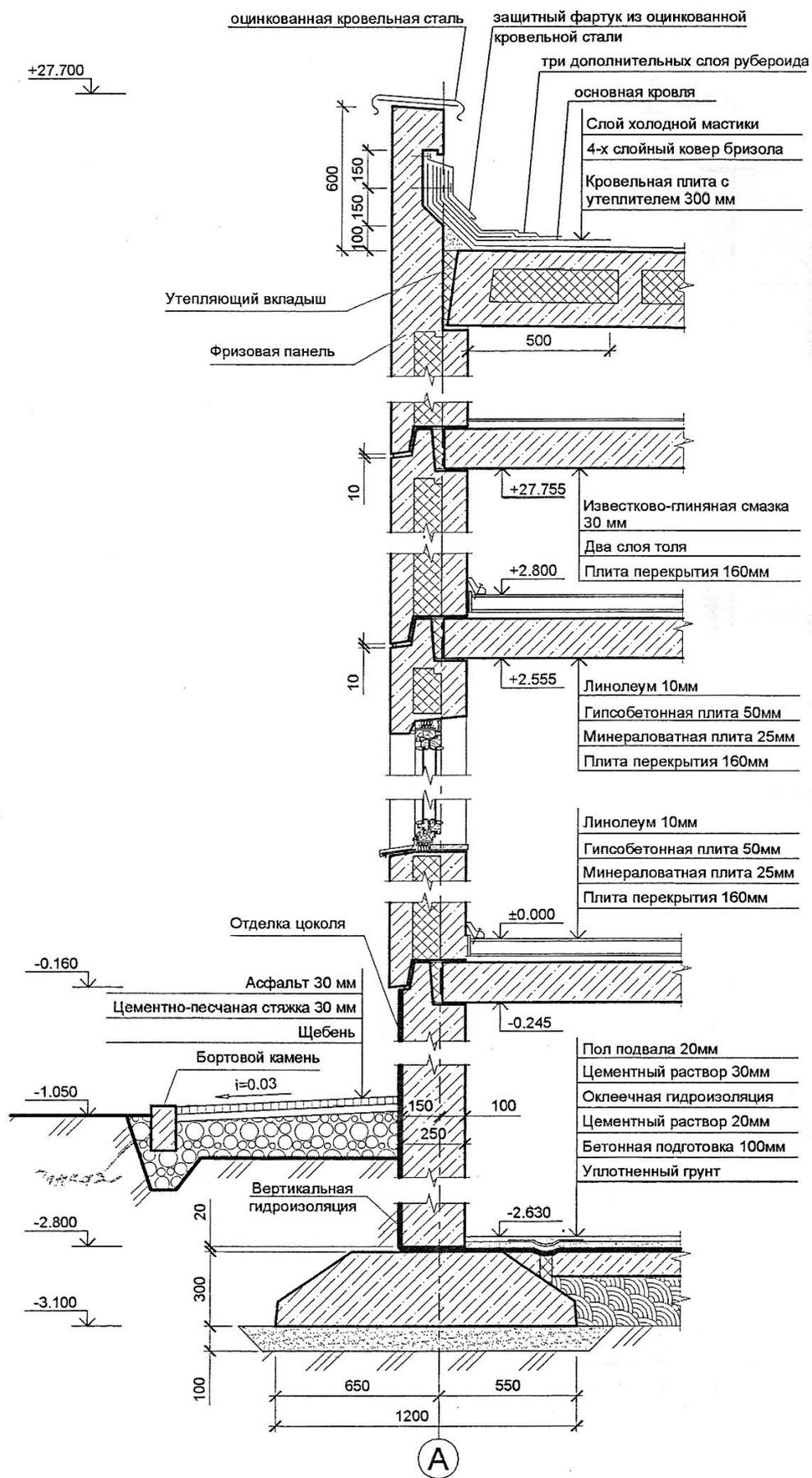
Рис. 21. Разрез по стене здания с плоской крышей
