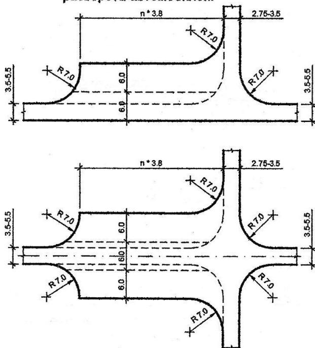
Рис. 47. Устройство автомобильных стоянок в уширениях проездов
