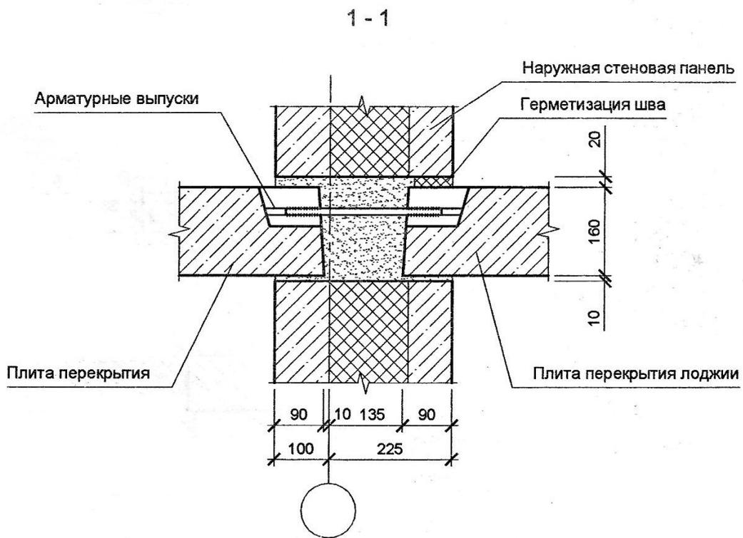
Рис. 32. Узел сопряжения элемента перекрытия с плитой лоджии
