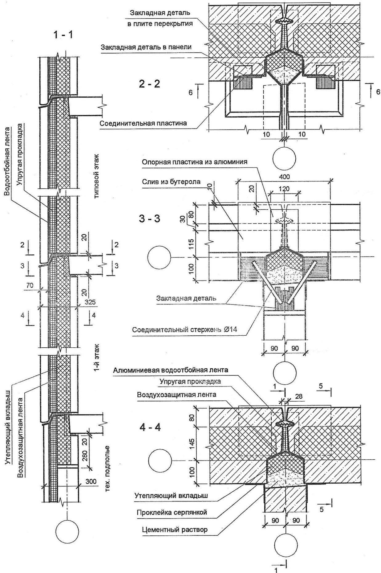
Рис. 33. Вариант конструктивного решения стыка рядовых панелей.
