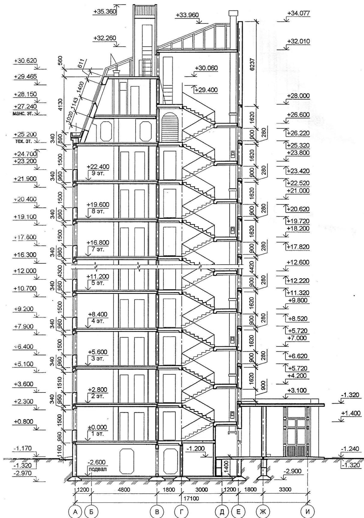
Рис. 17. Разрез 1 - 1 (по лестничной клетке).
