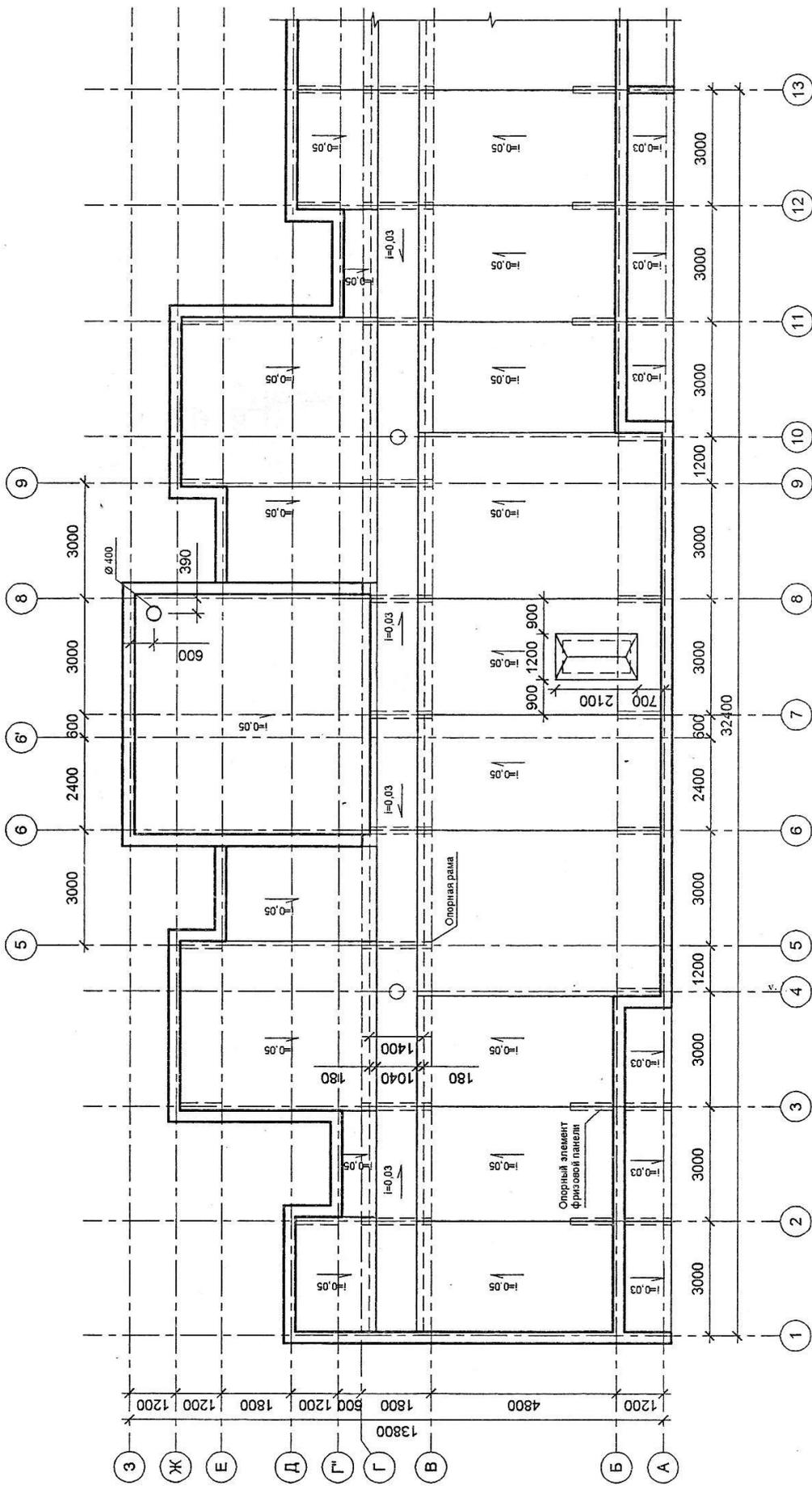
Рис. 16. План чердачной крыши с теплым чердаком и кровлей из рулонных материалов
