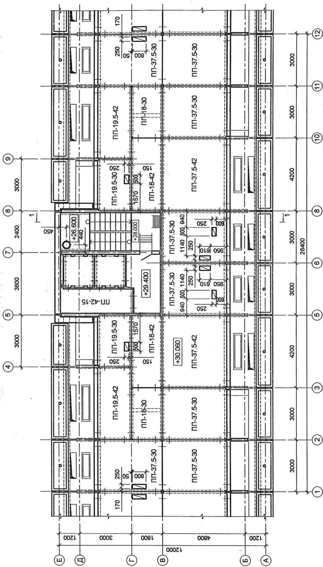
Рис. 13. План перекрытий мансардного этажа (на отметке +30.060)
