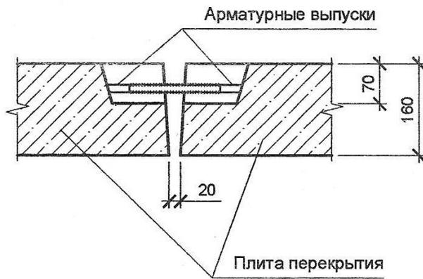
Рис. 31. Вариант конструктивного решения стыка плит перекрытия на гибких связях
