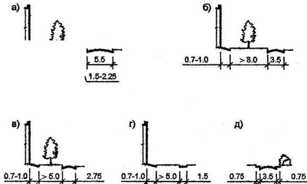
Рис. 45. Поперечные профили внутриквартальных проездов и дорожек:
