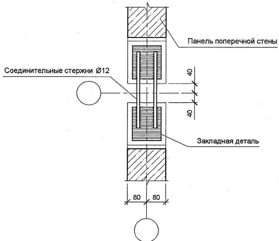
Рис. 25. Примеры сопряжения внутренних несущих стеновых панелей
