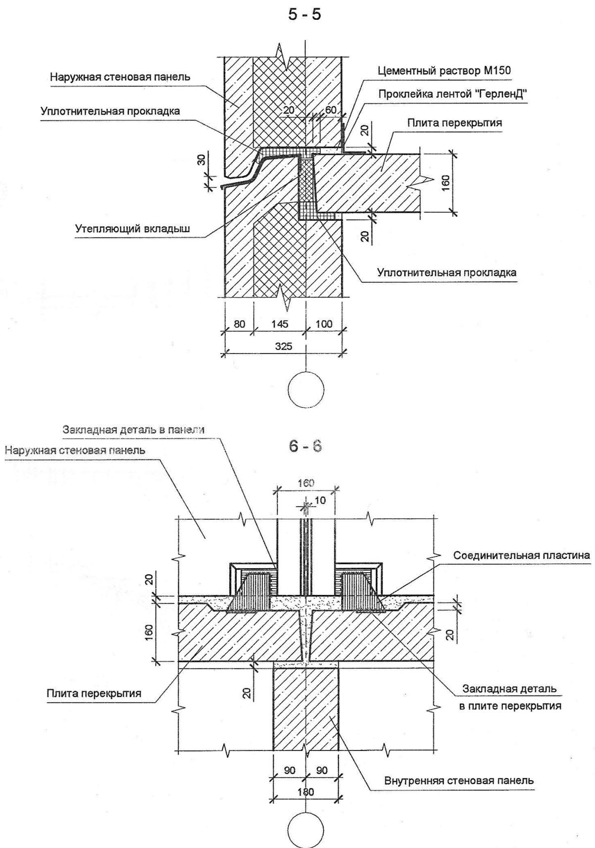
Рис. 34. Вариант конструктивного решения стыка рядовых панелей
