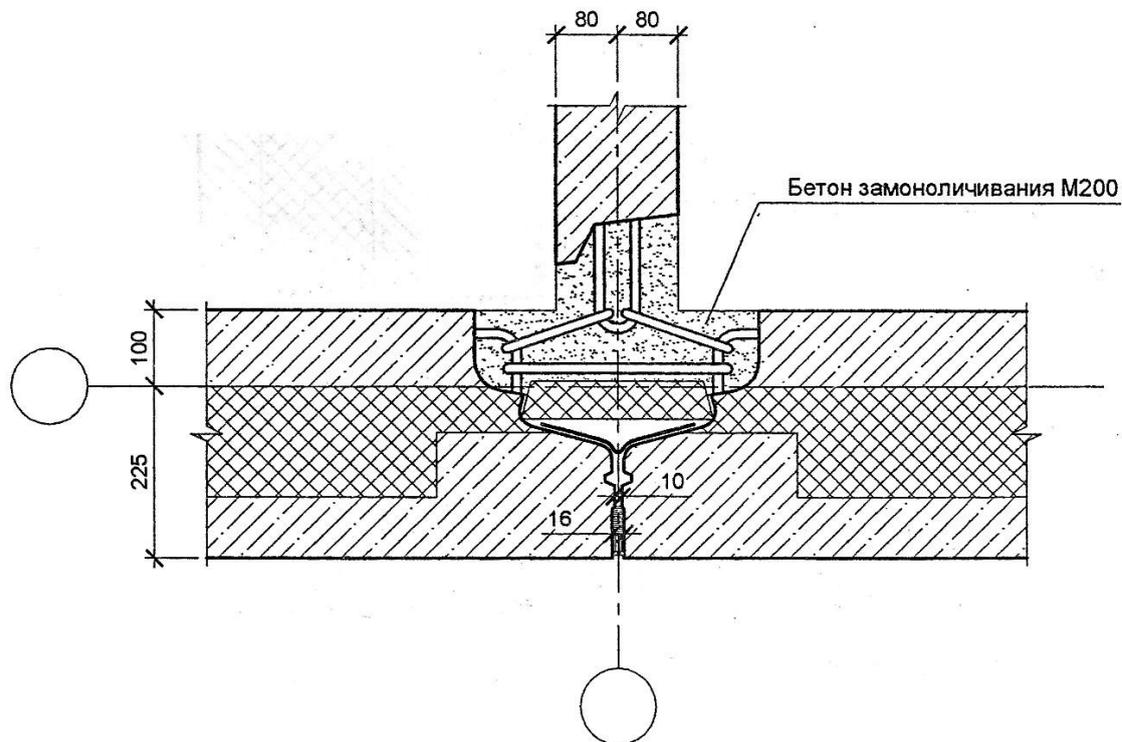
Рис. 26. Вариант конструктивного решения рядового стыка стеновых панелей
