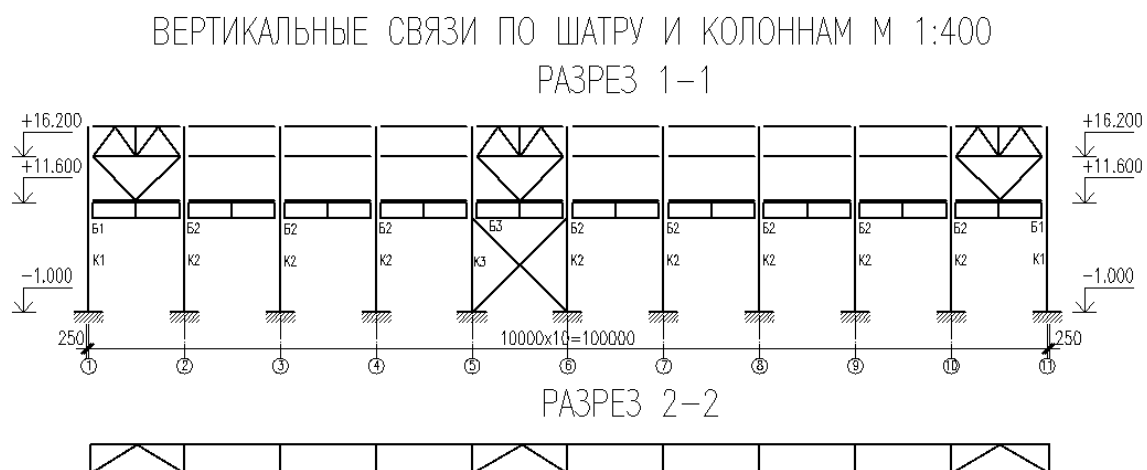
Рис. 2. Схема системы связей
