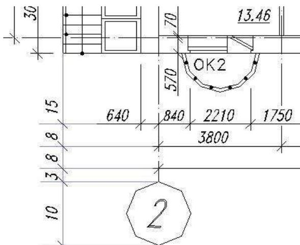
Рисунок 1 – Размещение размерных линий относительно контура объекта
