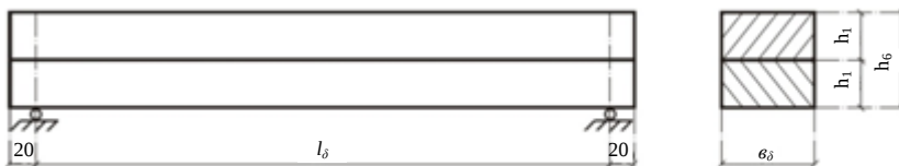
Рис. 4.1. Балка составного сечения без связей
