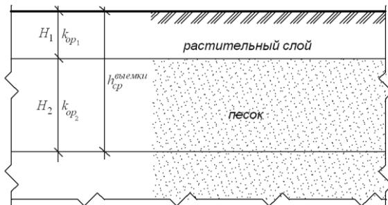
Рис. 9. Определение средней рабочей отметки в зоне выемки
