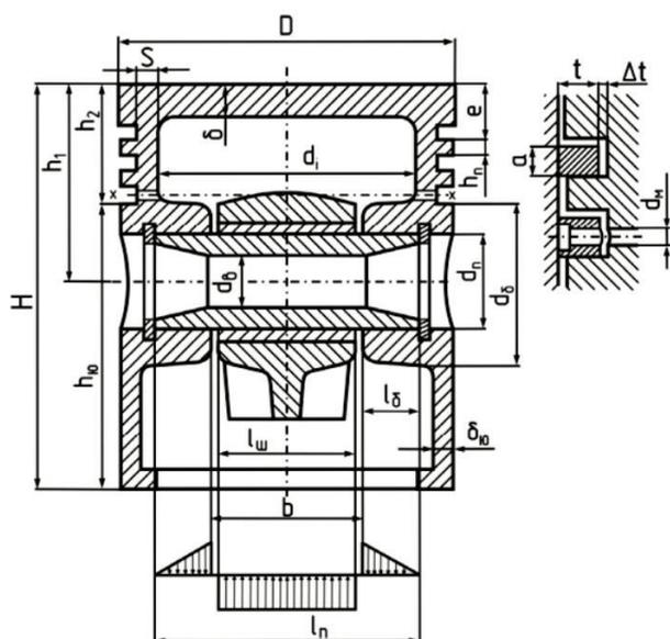
Рисунок 6.1 - Схема поршня
