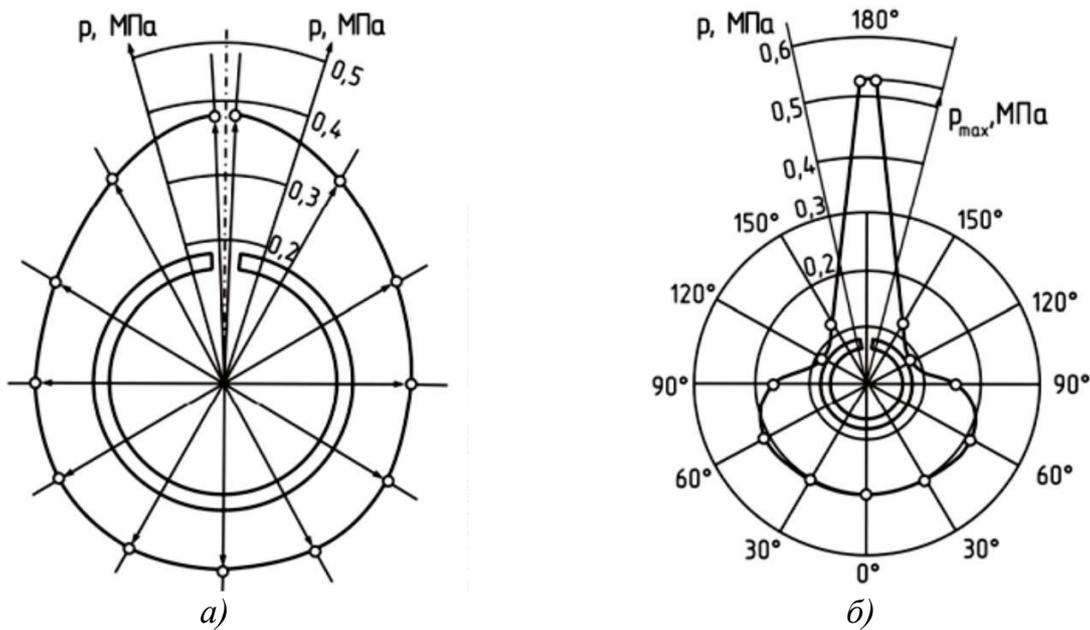
Рисунок 6.2. - Эпюры сил давления кольца на стенку цилиндра:
