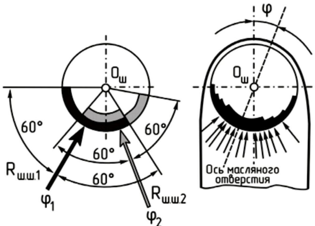
Рисунок 3.5 – Схема построения диаграммы износа шатунной шейки
