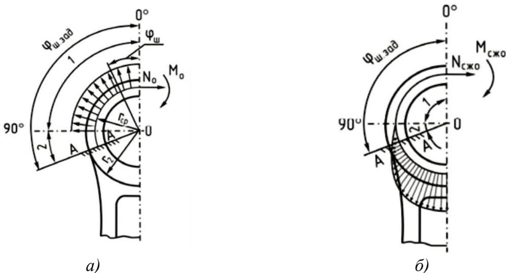
Рисунок 6.4 - Схема распределения нагрузок на поршневую головку шатуна:
