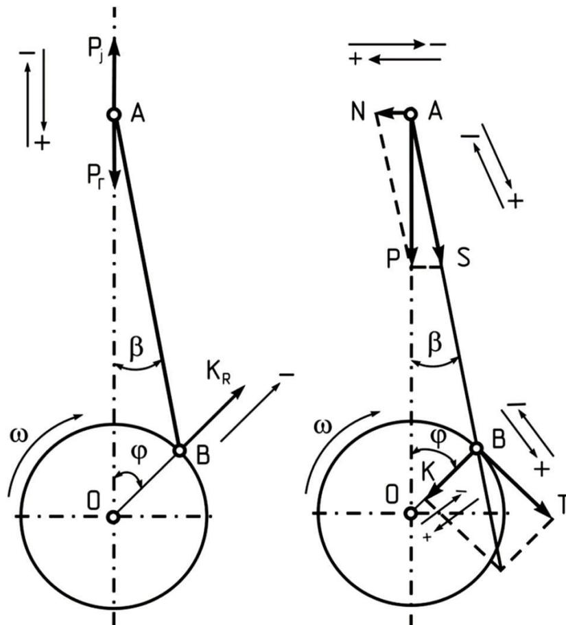
Рисунок П.7 - Схема сил, действующих в КШМ
