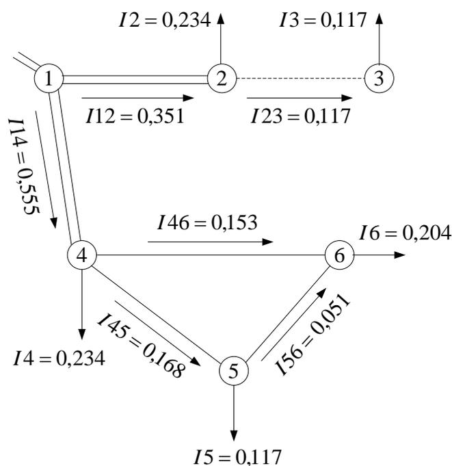
Рис. 4. Токораспределение в сети (токи указаны в кА)
