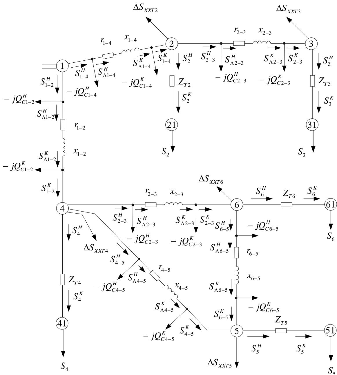
Рис. 6. Схема замещения варианта 2 для расчета установившегося режима
