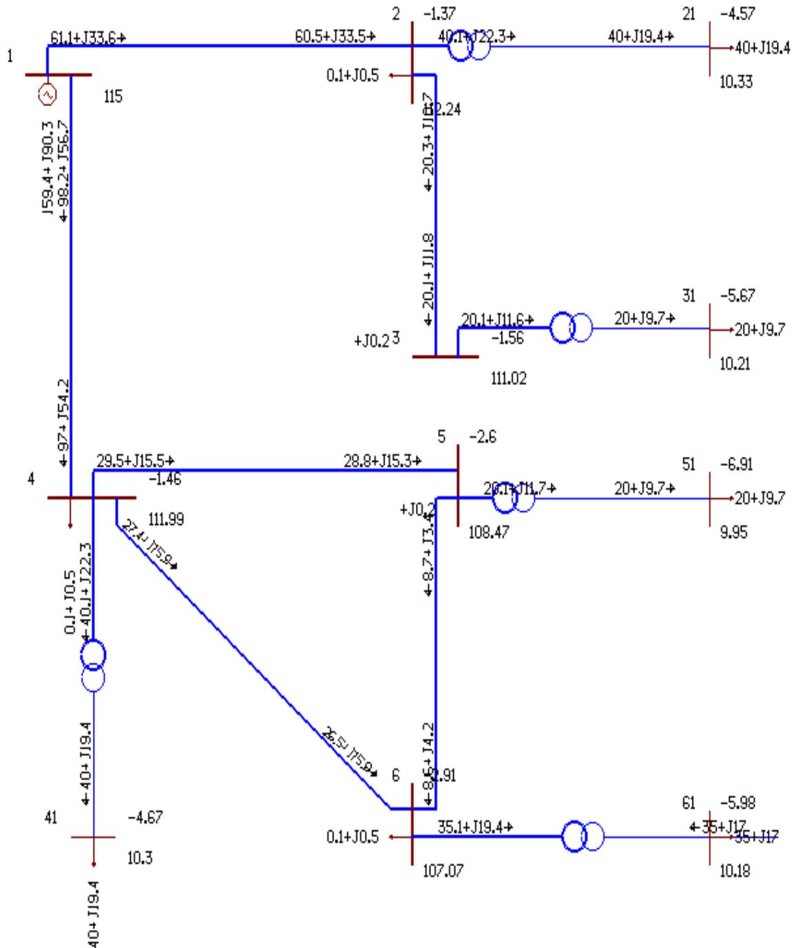
Рис. 8. Режим максимальных нагрузок варианта 2 (после регулирования напряжений)
