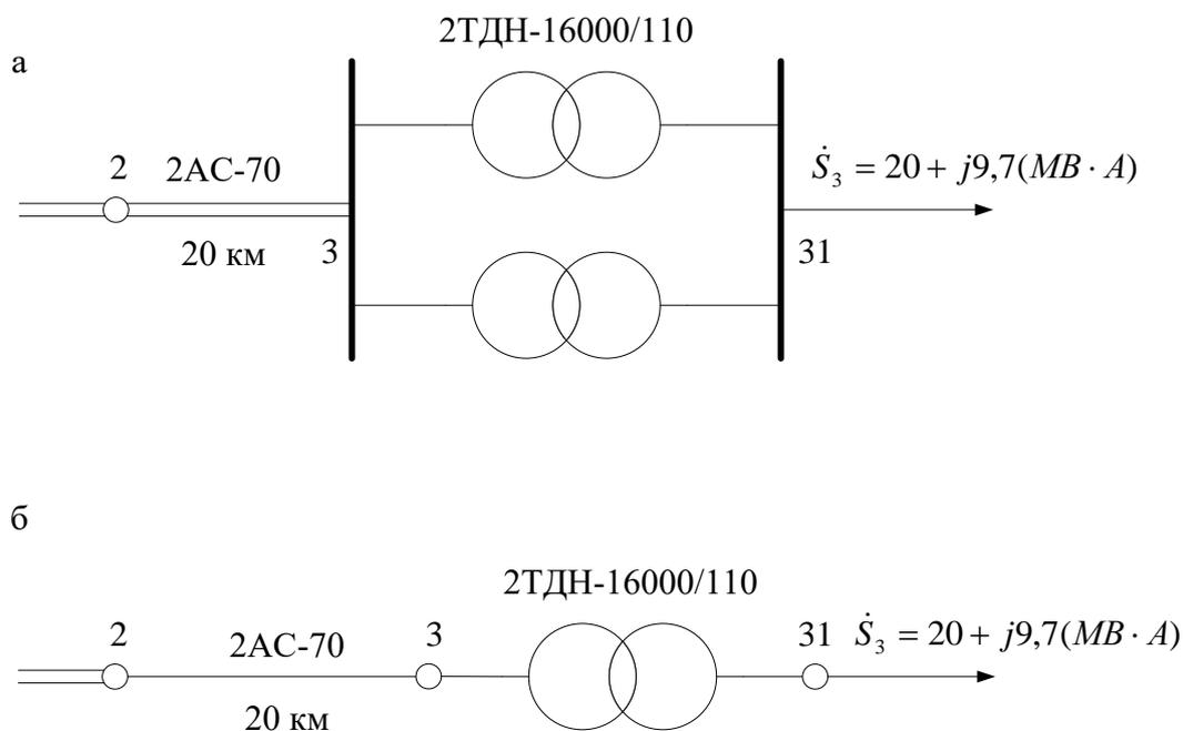
Рис. 5. Схема присоединения узла 3:
