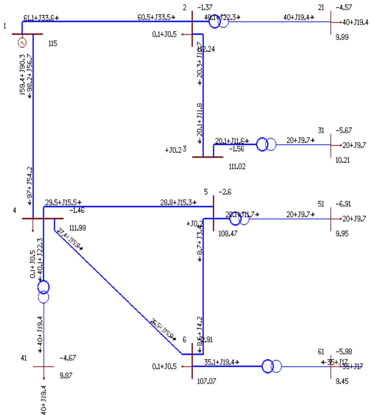
Рис. 7. Режим максимальных нагрузок варианта 2 (до регулирования напряжений)
