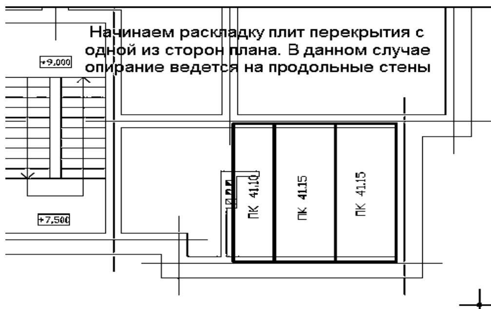
Рисунок 8. Начальный этап раскладки плит
