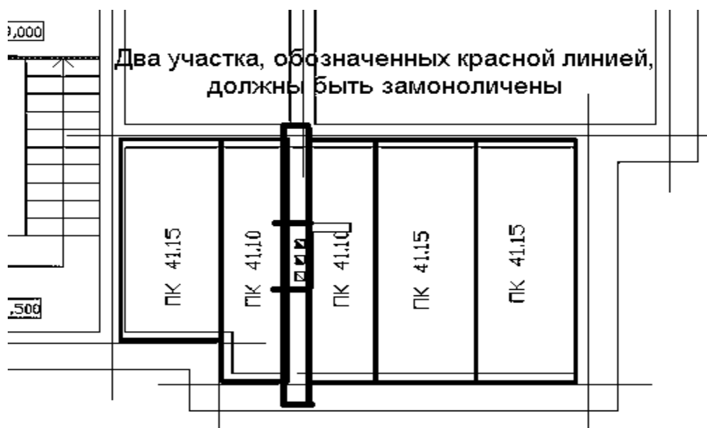
Рисунок 8. Завершающий этап раскладки плит
