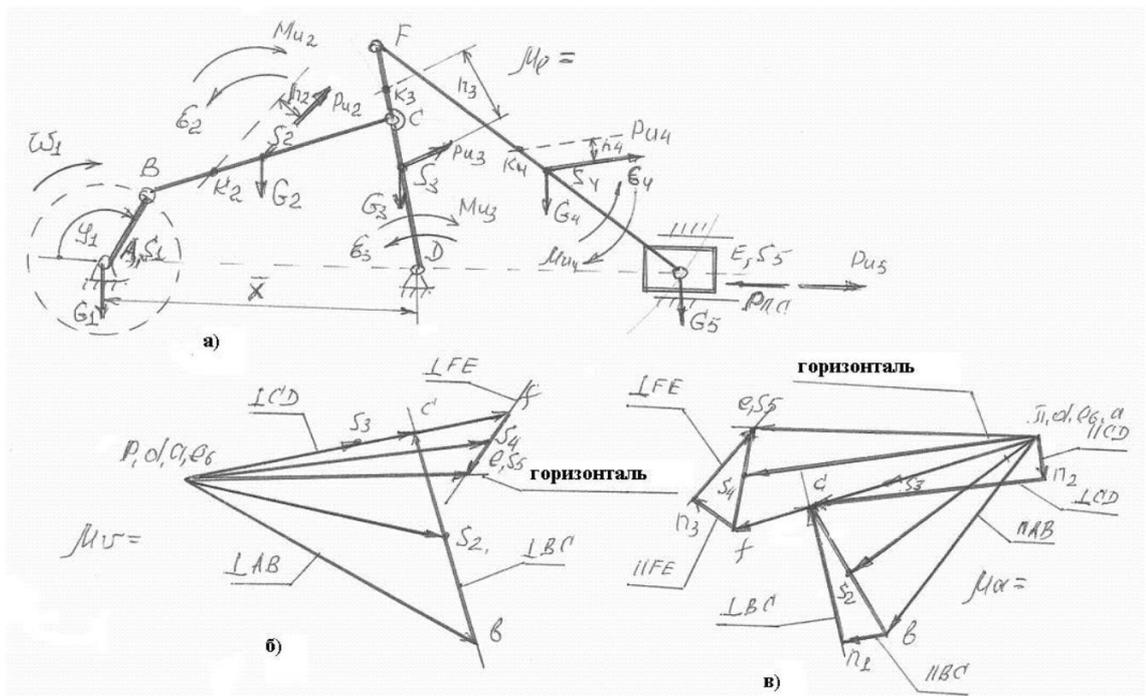
Рис. 1 Кинематическая схема механизма – а,
