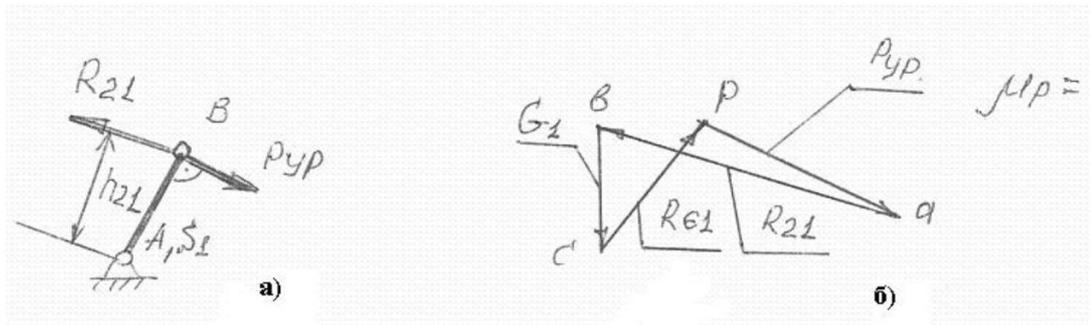
Рис. 4 Кинематическая схема ведущего звена – а
