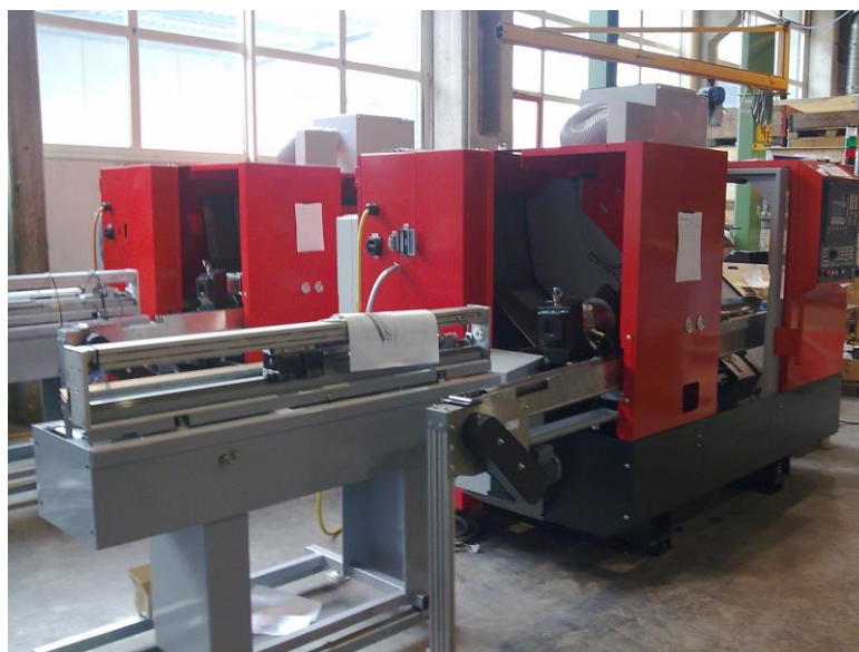
Рис.4. Загрузчик EMCO COMPACT LOAD E65 (R6Z930) к токарному станку EMCOTURN E65TM
