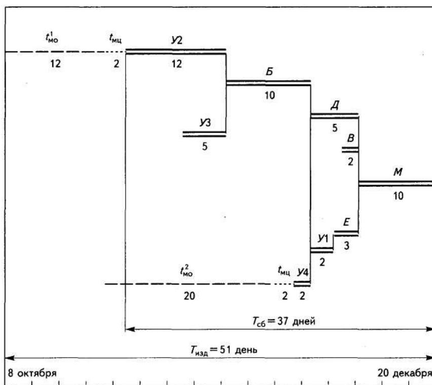
Рис. 2 - Цикловой график сборки изделия (пример)
