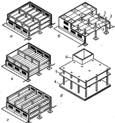
1.1.13. Назовите конструктивную схему каркасного здания, изображенного на рисунке (1 – колонныкаркаса; 2 – сборный или монолитный настил перекрытия):
