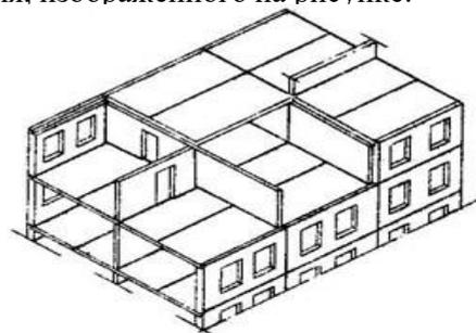
1.1.8. Назовите конструктивную схему бескаркасного здания, изображенного на рисунке:
