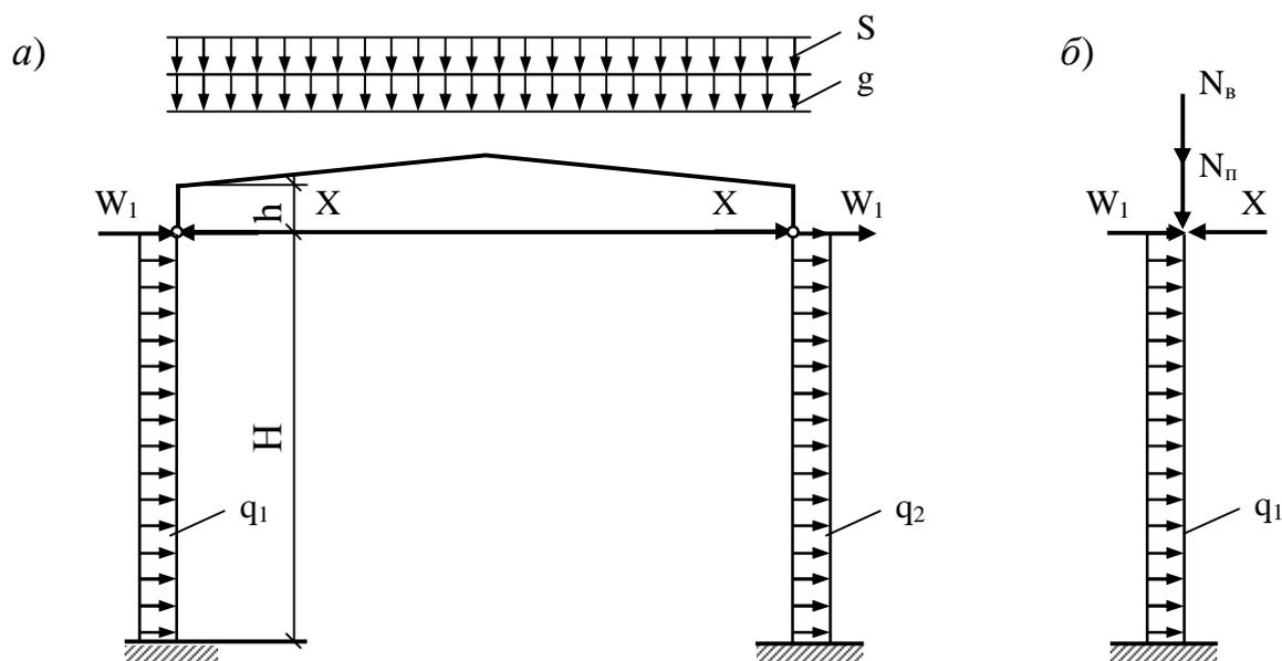
Рис. 5.9. Расчётная схема рамы (а) и стойки (б)
