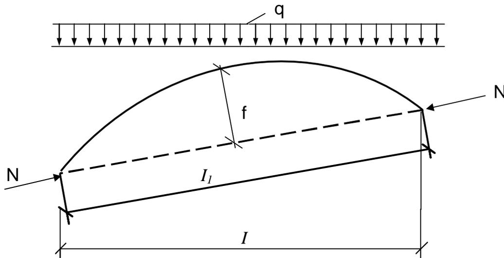
Рис. 5.7. Расчётная схема панели верхнего пояса сегментной фермы
