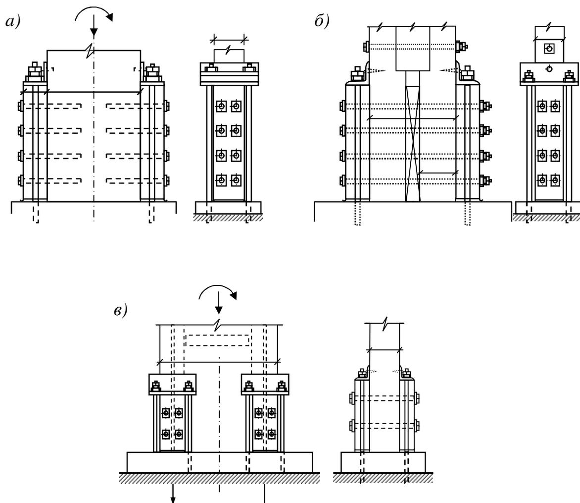
Рис. 5.11. Конструкции закрепления стоек в фундаментах:
