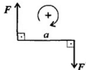
13. «Силу можно перенести параллельно линии ее действия силы, при этом нужно добавить пару сил с моментом, равным произведению модуля силы на расстоянии, на которое перенесен сила». Речь идет о теореме:
