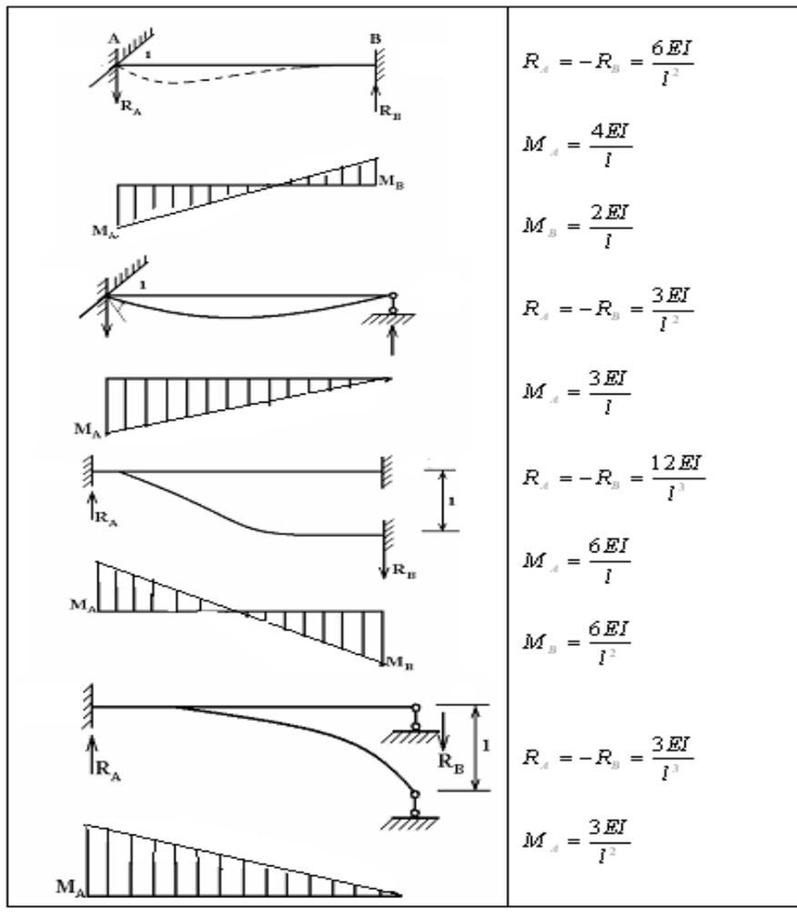
Для стержней 2,4,5  $V=0$ , т.к. отсутствуют продольные силы. Строим единичные эпюры  $M_1$ ,  $M_2$ ,  $M_3$ , используя таблицы 1 или 2. Эти эпюры представлены на рис. 3. Т.к. в стержнях 2,4 отсутствуют продольные силы, то
