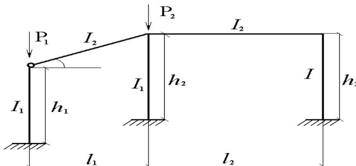
Рис.1 Расчетная схема плоской рамы
