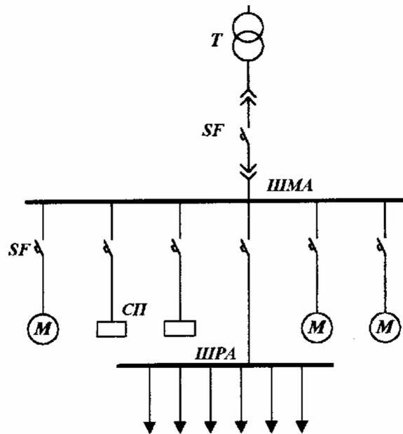
Рис. 9.3. Схема блока трансформатор - магистраль для однитрансформаторной подстанции.
