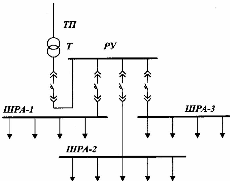
Рис. 9.2. Магистральная схема с распределением электроэнергии.
