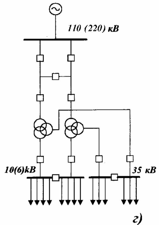
Рис. 5.1. Характерные схемы внешнего электроснабжения промышленных предприятий.
