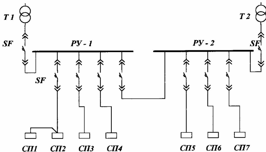
Рис. 9.1. Радиальная схема распределения электроэнергии.
