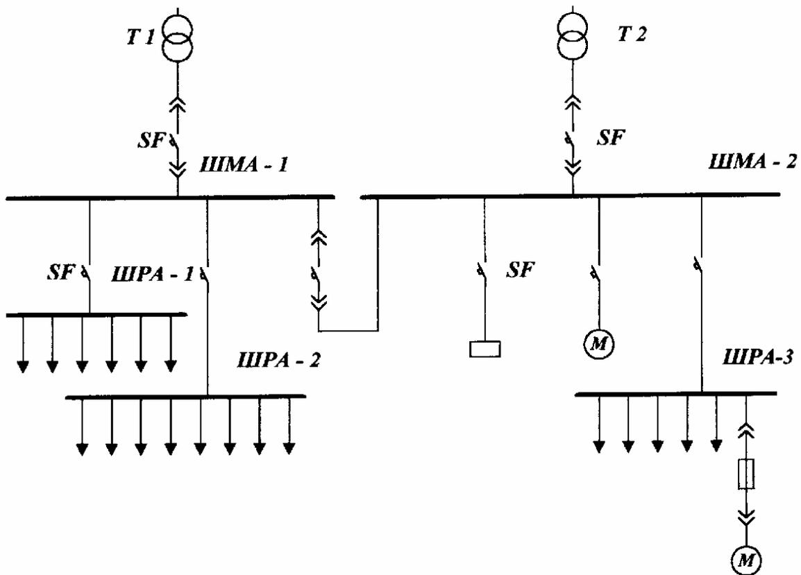
Рис. 9.4. Схема блока трансформатор - магистраль для двухтрансформаторной подстанции.
