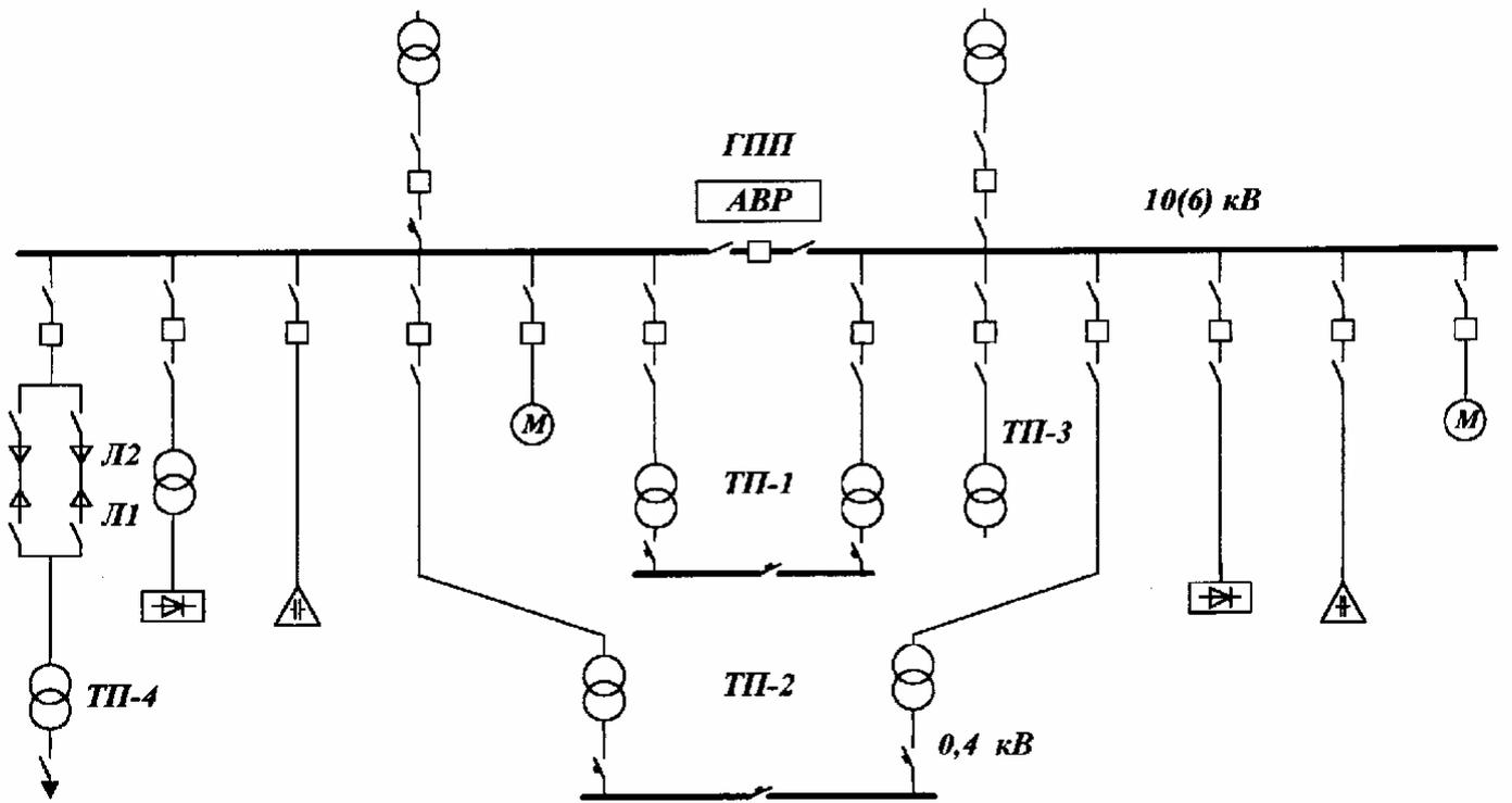
Рис. 5.2 Одноступенчатая радиальная схема внутреннего распределения электроэнергии
