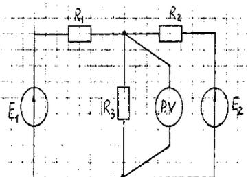
В электрической схеме определить показание вольтметра.
