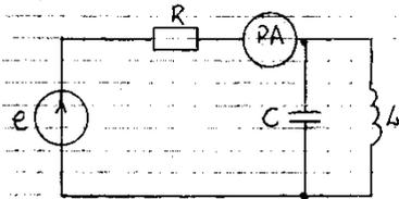
Определить показание амперметра электромагнитной системы.
