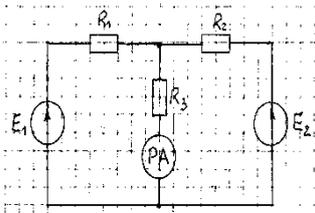
В электрической схеме определить показание амперметра.
