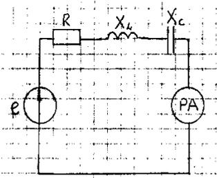
Определить показание амперметра.
