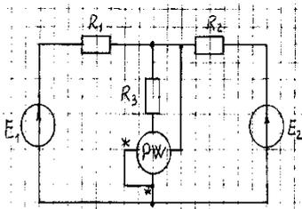
В электрической схеме определить показание ваттметра.
