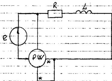
Определить показание ваттметра.
