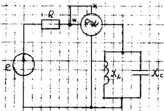
Определить показание ваттметра.
