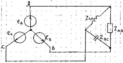
Определить фазный ток нагрузки, соединенной в «треугольник».
