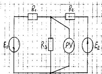
В электрической схеме определить показание вольтметра.
