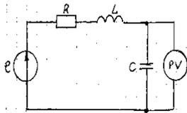
Определить показание вольтметра электромагнитной системы.
