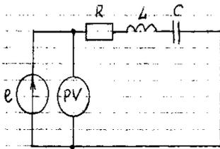
Определить показание вольтметра электромагнитной системы.
