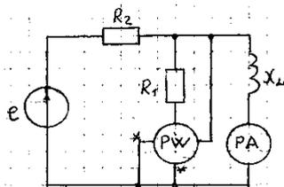
Определить показание ваттметра, если амперметр показывает 5 А.
