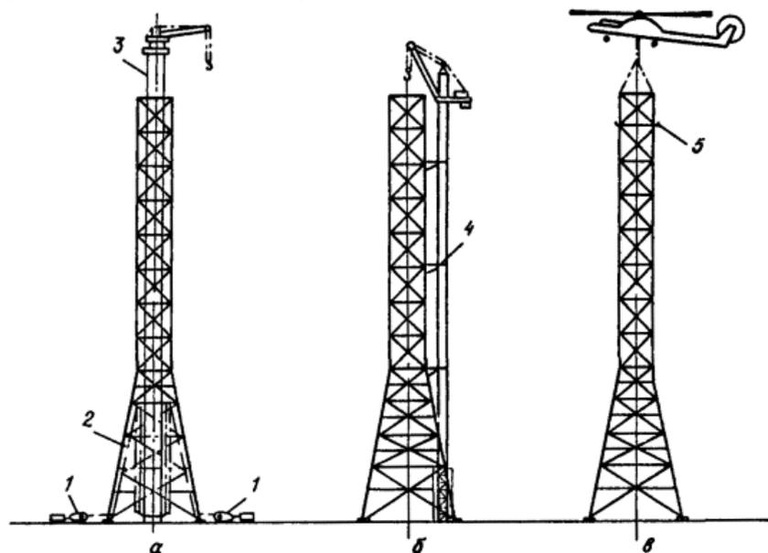
**Вопрос 17:** На рисунке показана схема монтажа вытяжных башен поворотом. Выберите правильный вариант ответа.
