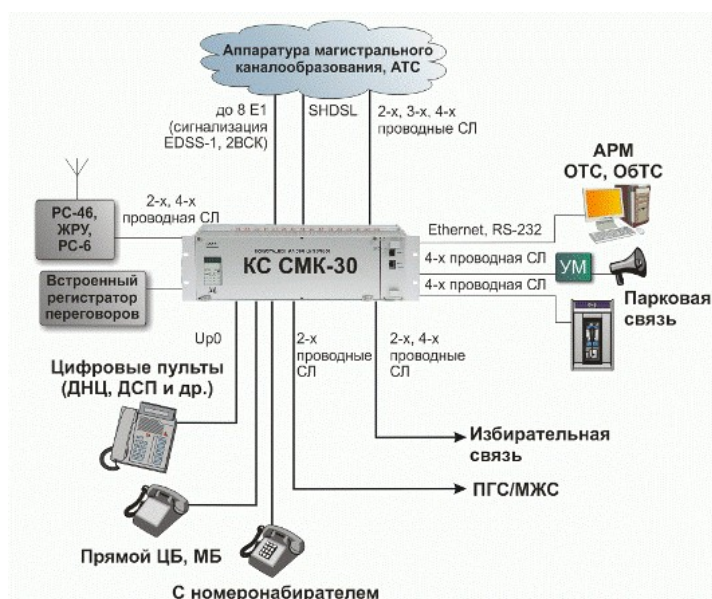
Рисунок 1.1 - Структурная схема аппаратно-программного комплекса связи на СМК-30
