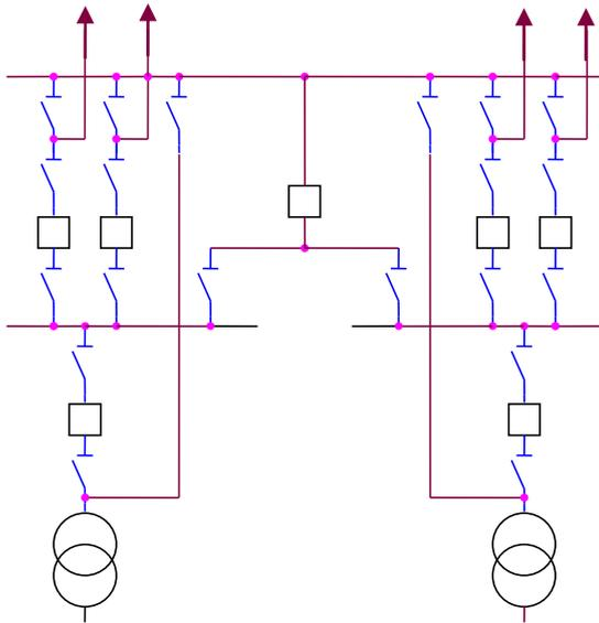
Рис. 4.11. Секционированная система шин с обходной системой шин
