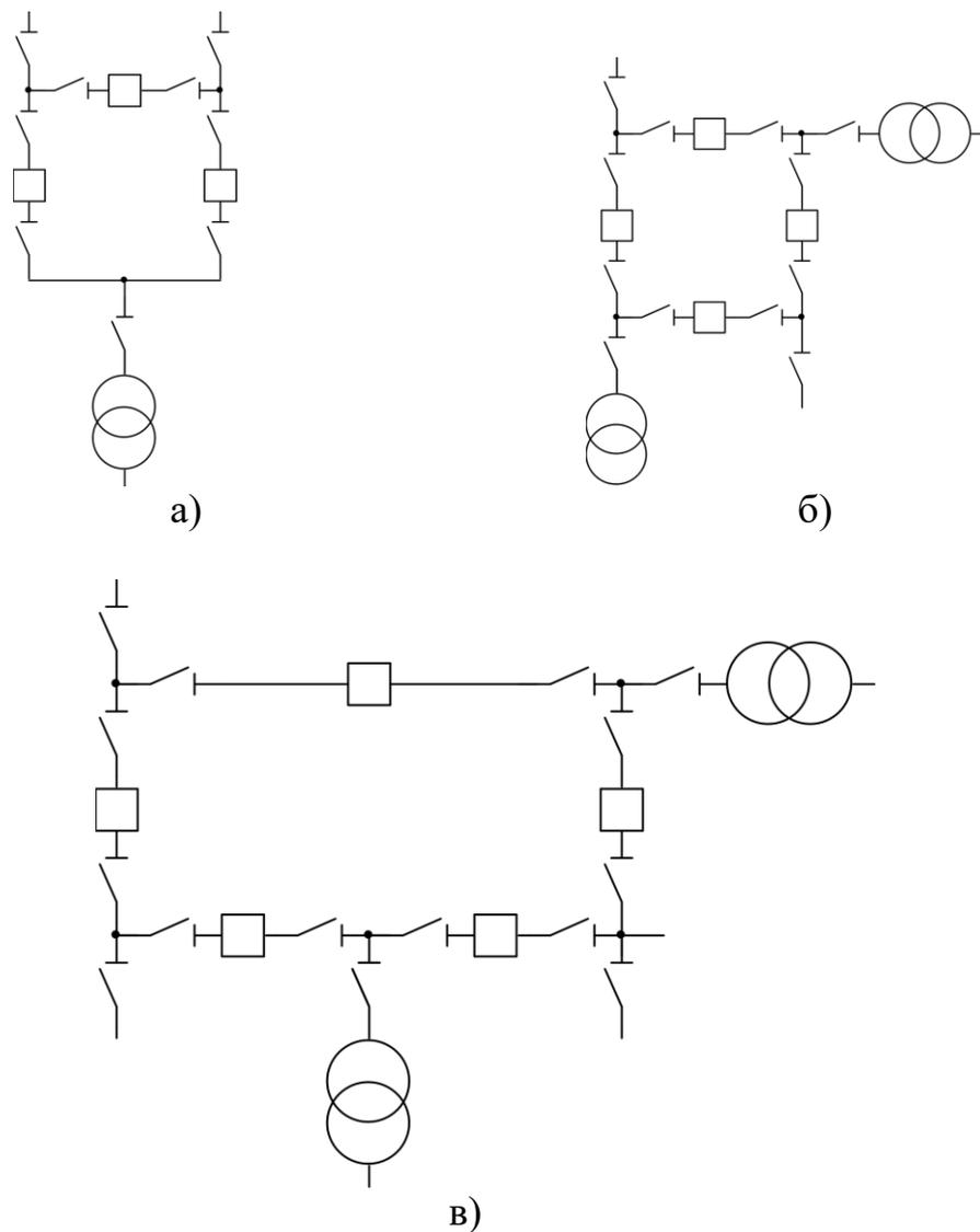
Рис. 4.19. Схема многоугольников
