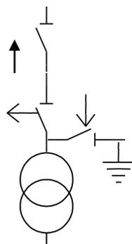
Рис. 4.3. Блок “линия-трансформатор”
