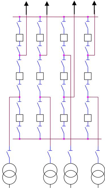
Рис. 4.17. Полуторная схема
