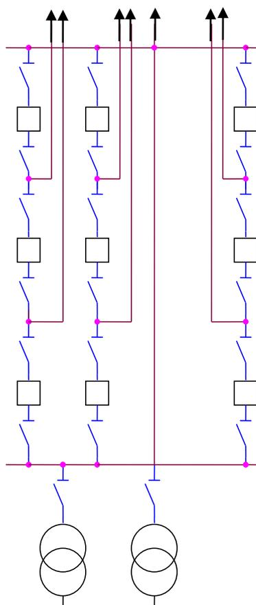
Рис. 4.16. Трансформатор - шины
