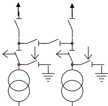
Рис. 9.4. Блок “линия-трансформатор”
