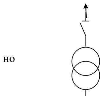
Рис. 4.1. Блок “линия-трансформатор”
