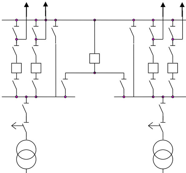
Рис.4.10. Секционированная система шин с обходной системой шин
