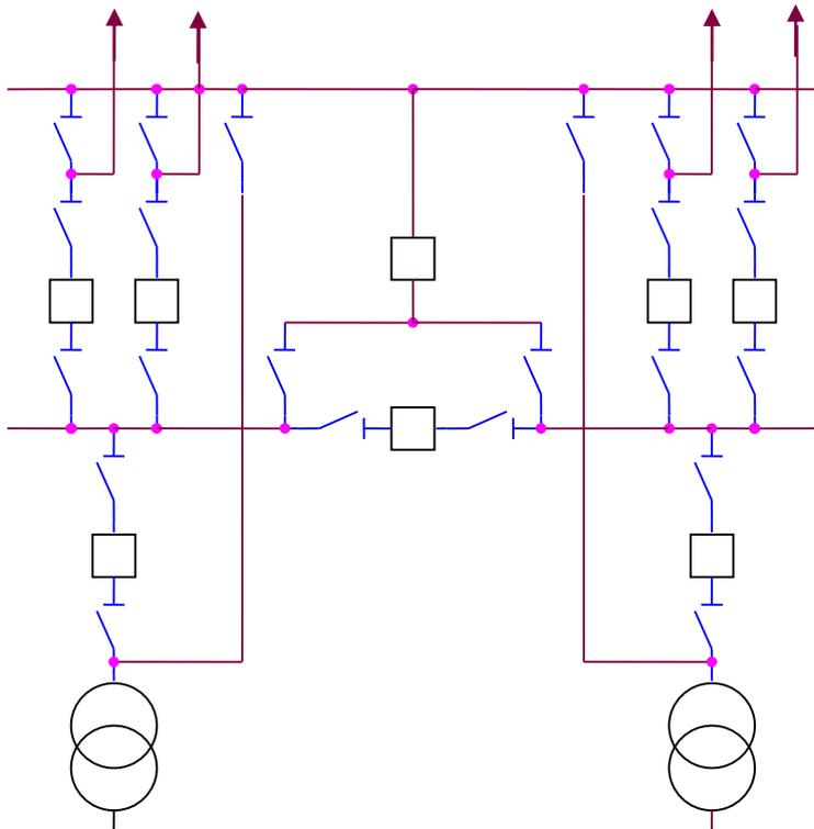
Рис. 4.12. Секционированная система шин с обходной системой шин
