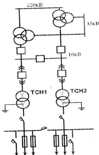
Рис. 4.21 Схема питания собственных нужд подстанции подстанций
