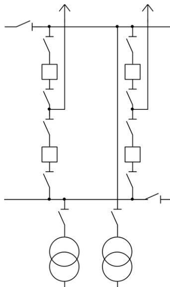
Рис.4.8. Расширенный четырехугольник
