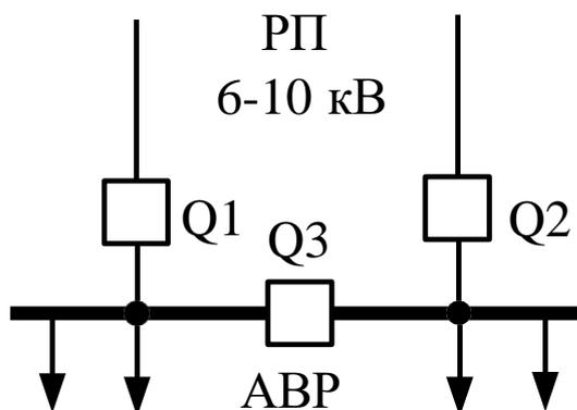
Рисунок 7 – Схема РП на напряжении 6-10 кВ
