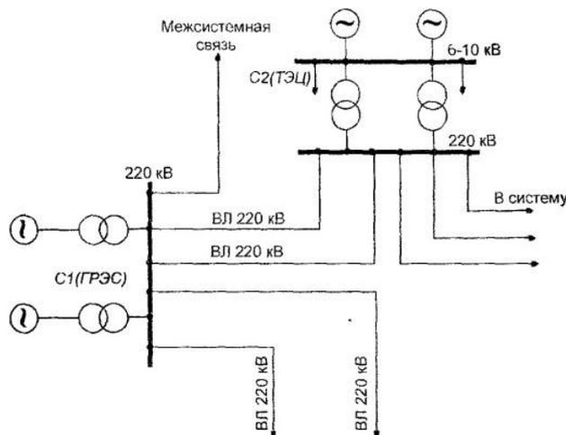
Рисунок 3.1 – Схема электрической сети
