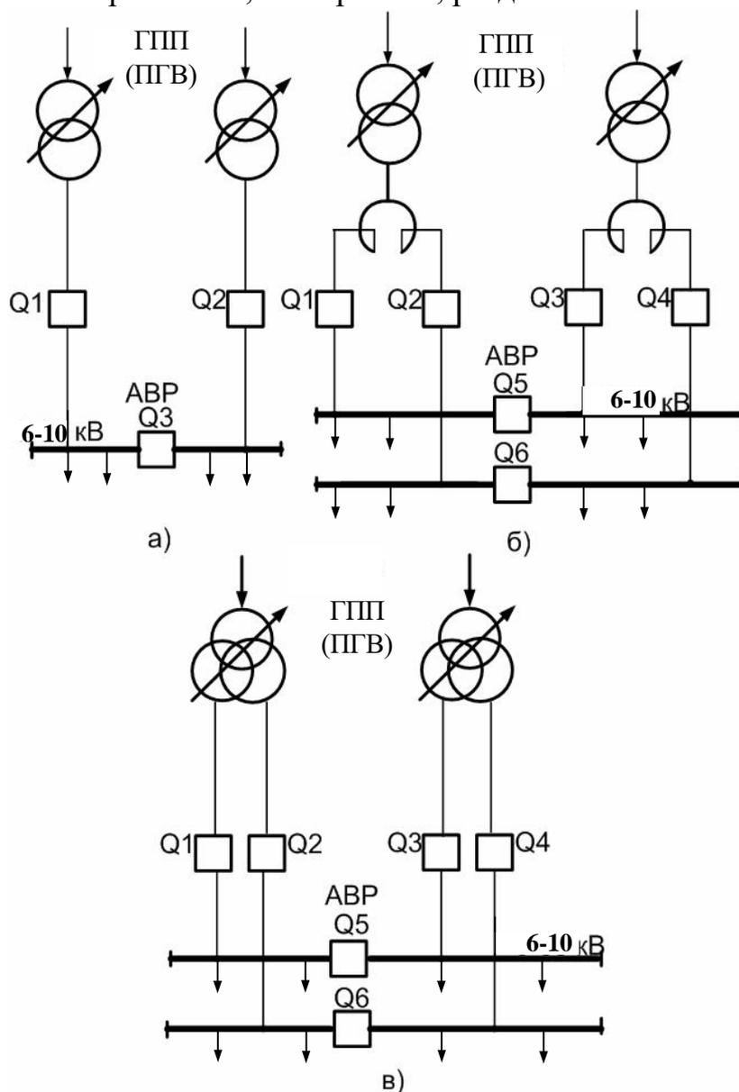
Рисунок 6 - Схемы ГПП на напряжении 6-10 кВ
