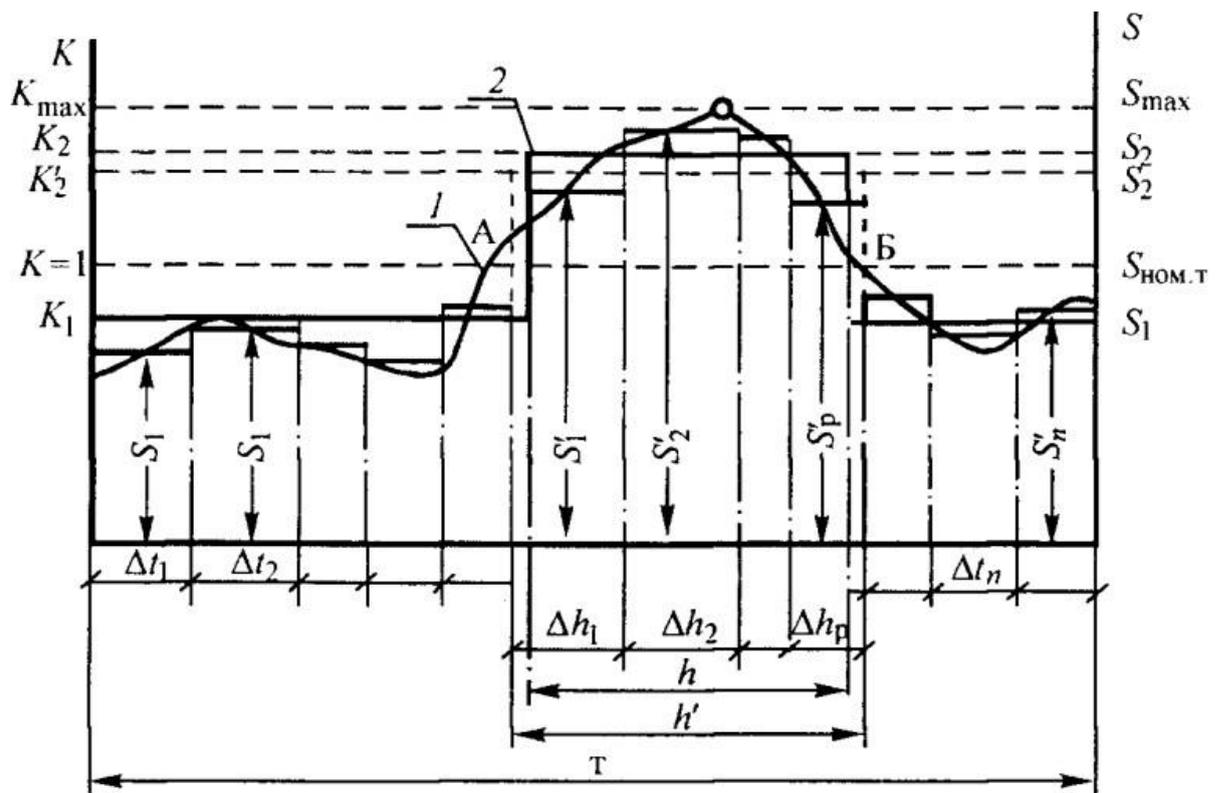
Рисунок 1 - Преобразование исходного графика нагрузки трансформатора в эквивалентный 1 - исходный график нагрузки, 2 - эквивалентный прямоугольный график нагрузки
