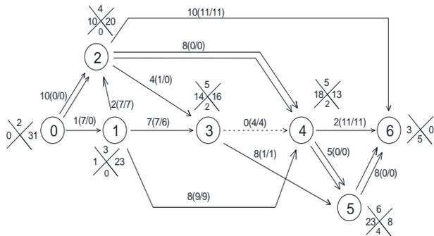
Рис. 10. Безмасштабный сетевой график, рассчитанный методом потенциалов
