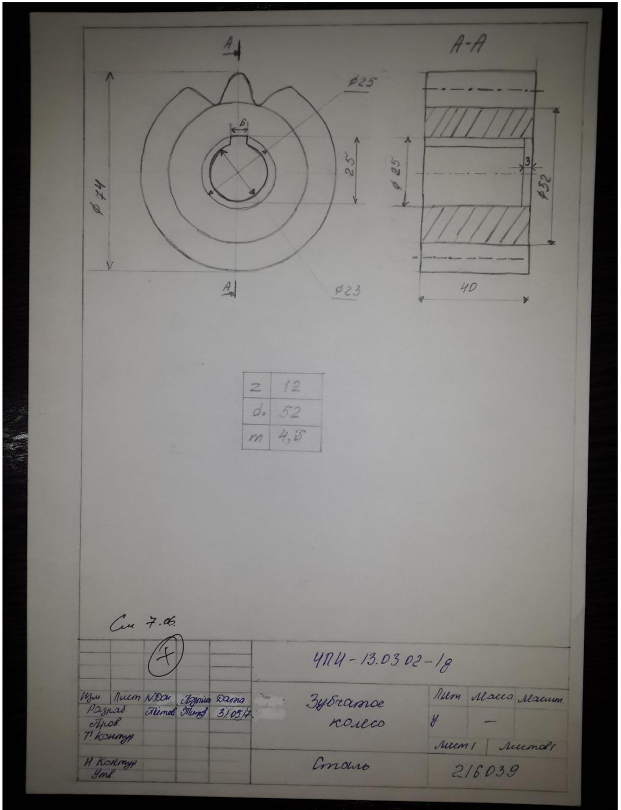
Рисунок 3- Пример оформления эскиза детали, формат А4
