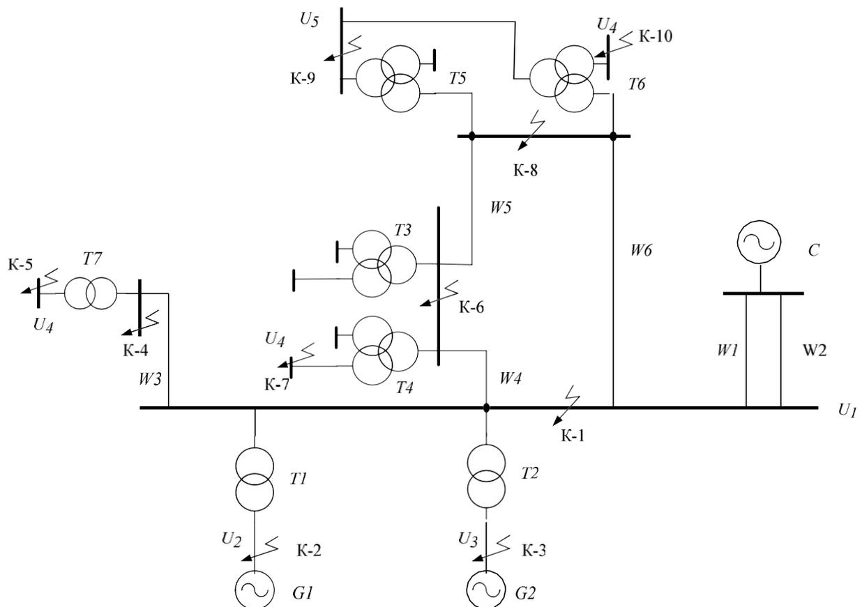
Рисунок 1 – Схема для определения токов КЗ
