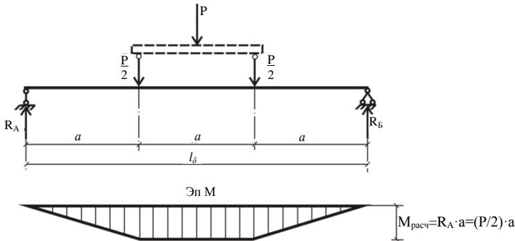
Рис. 5.2. Расчетная схема образца балки и эпюра М
