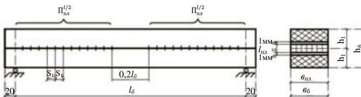
Рис. 5.1. Балка составного сечения с упругоподатливыми связями
