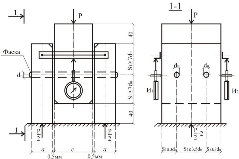
Рис. 1.1. Образец соединения деревянных элементов на цилиндрических нагелях
