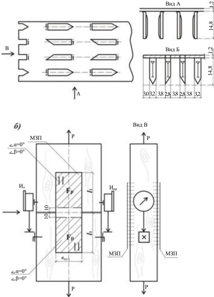
Рис. 2.1. Образец соединения деревянных элементов на металлических зубчатых пластинах: а) конструкция пластины МЗП – 1,2; б) образцы соединения ( $\alpha = 0^\circ$ ,  $\beta = 0^\circ$ )
