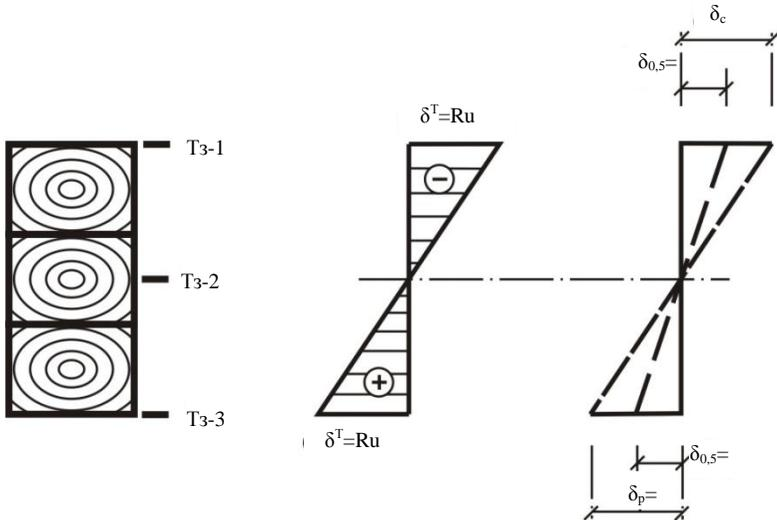
Рис. 3.4. Эпюры нормальных напряжений по высоте сечения балки:
