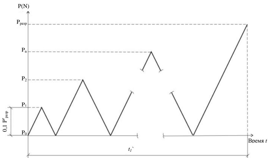
Рис. 1.3. Схема нагружения образца
