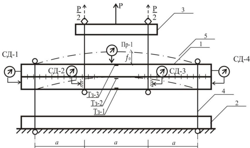
Рис. 5.3. Схема испытательной установки на машине P-10:
