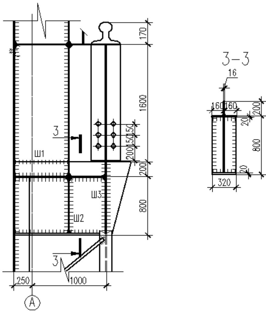
Рис. 7. Сопряжение верхней и нижней частей колонны
